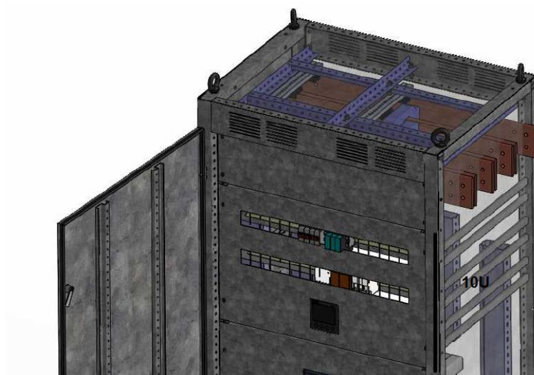
Figura 47-Simulação do compartimento de equipamentos modulares no SolidWorks. Fonte Jayme da Costa.
