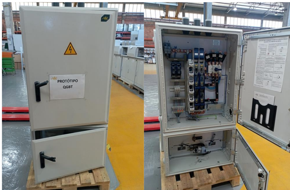
Figura 1-Invólucro de um QGBT, Fonte: Jayme da Costa.
