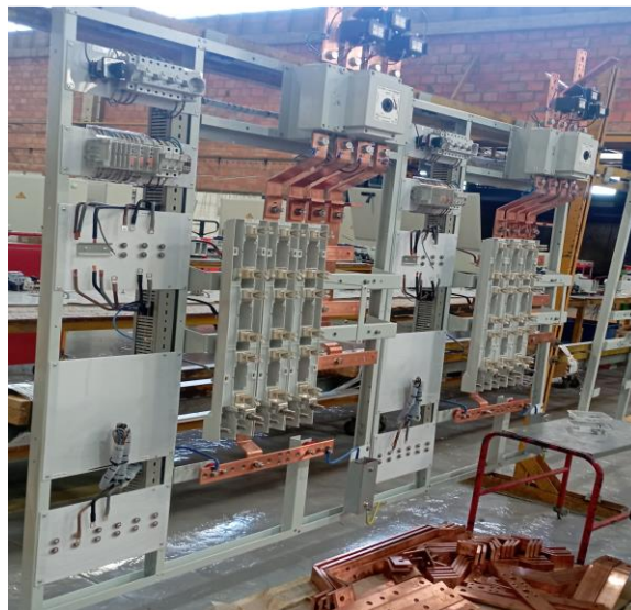
Figura 2-Bastidor de um quadro aberto, Fonte: Jayme da Costa.
