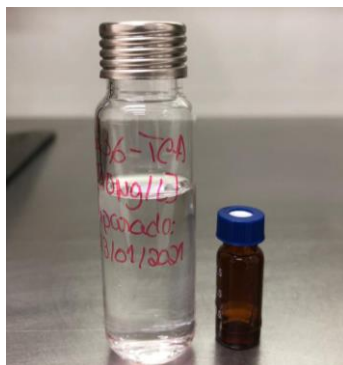
Figura 3.4: Vials utilizados para o padrão interno (vial à esquerda) e para as soluções de stock I e II (vial à direita).
