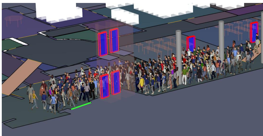
Figura 34 – Estrangulamento do fluxo de pessoas no corredor principal junto aos elevadores.
