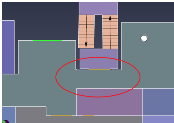
Figura 38 – Vista superior do corredor onde existe um bottleneck (2º cenário)
