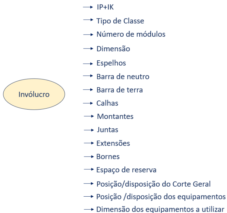
Figura 28 — Principais características a ter em consideração na escolha do invólucro [Criação própria]
