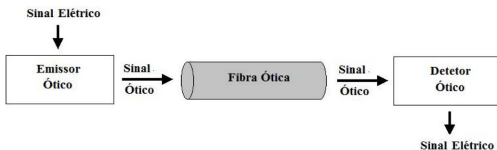
Figura 41: Esquema de transmissão genérico de sinais em fibra óptica [47]
