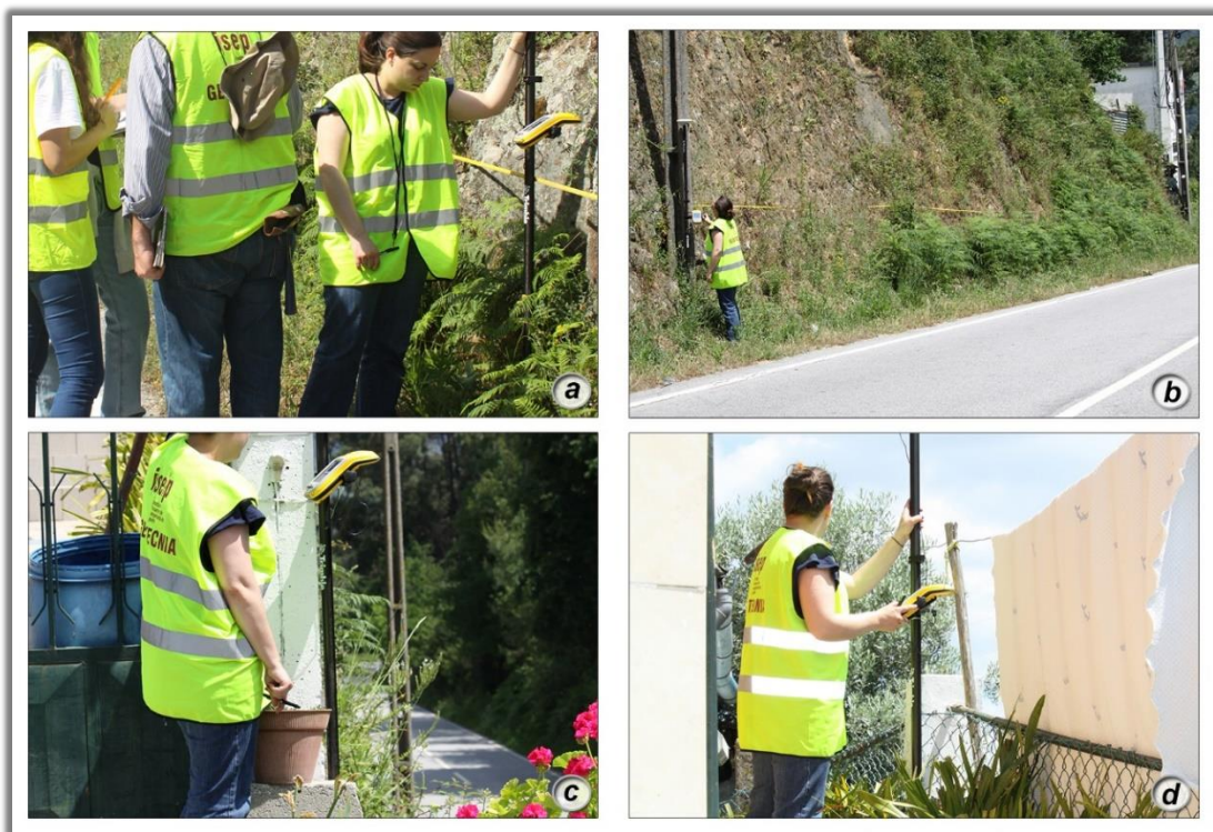
Figura 5.2 – Exemplo da utilização do GPS de alta precisão Trimble® GeoExplorer na georreferenciação de pontos de controlo para o levantamento VANT: a e b) nível inferior do talude rochoso; c, d) na parte superior do talude rochoso de Mourilhe.
