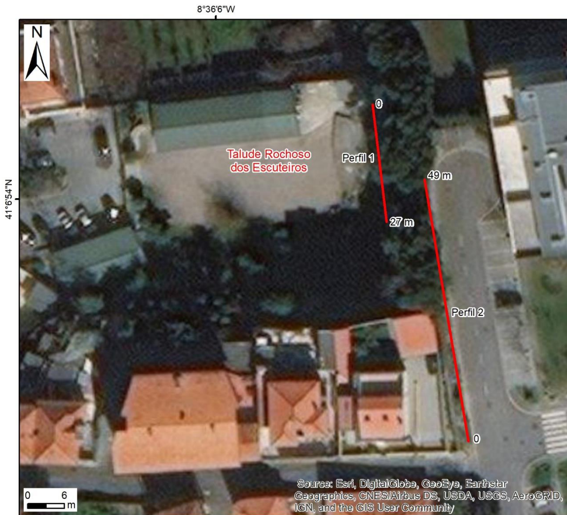
Figura 4.1 – Localização esquemática dos perfis aplicados para o desenvolvimento da técnica de amostragem linear no talude rochoso dos Escuteiros, Santo Ovídio (Vila Nova de Gaia).
