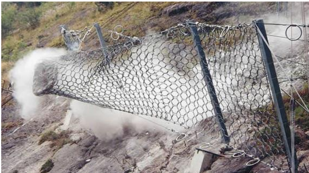
Figura 3.31 – Recolha de detritos com a solução de barreiras flexíveis ( www.mountaintech.cl ).
