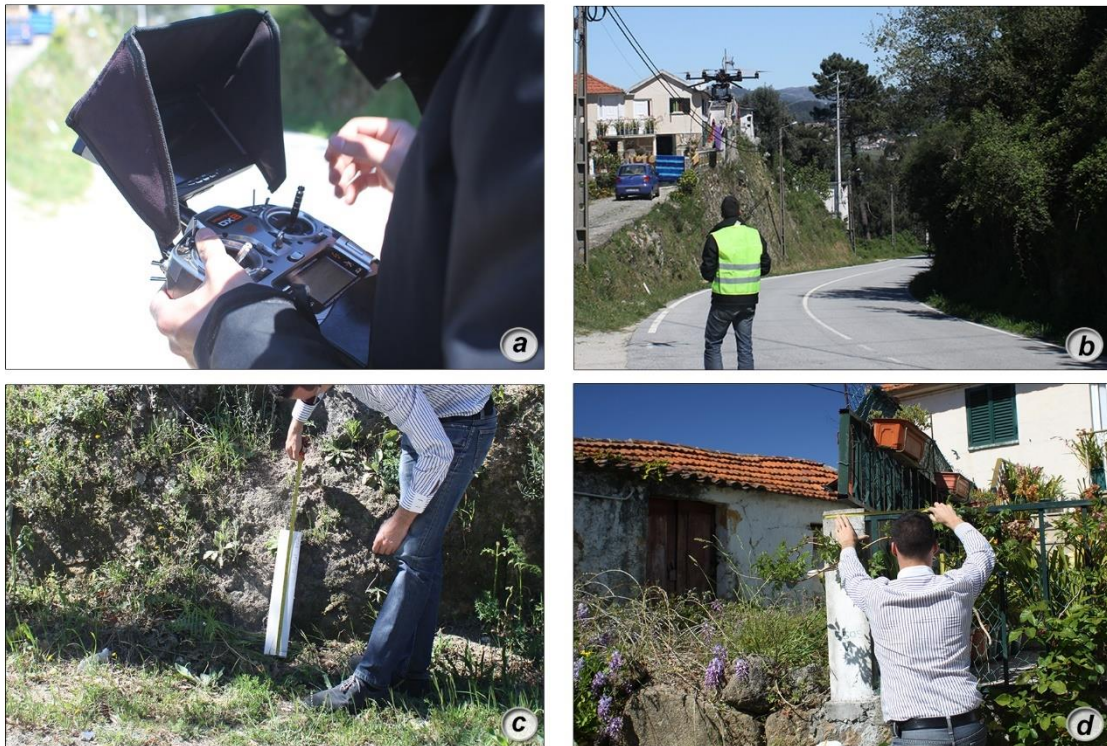
Figura 3.21 – Aspectos da monitorização com o VANT, com aplicação ao caso de estudo do talude rochoso de Mourilhe: a) aparelho de controlo do VANT; b) VANT em operação; c e d) medições de controlo para a calibração do modelo a gerar a partir do VANT.
