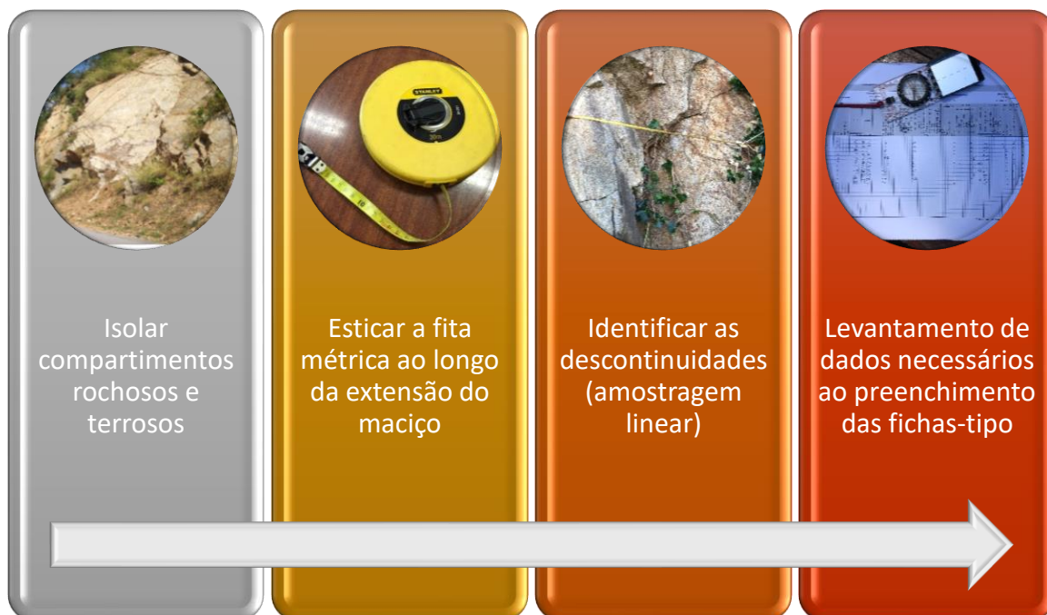
Figura 2.10 – Faseamento da técnica de amostragem linear (Scanline).
