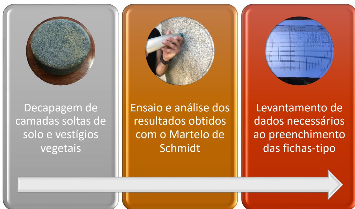
Figura 2.14 – Faseamento da análise de descontinuidades com o martelo de Schmidt .
