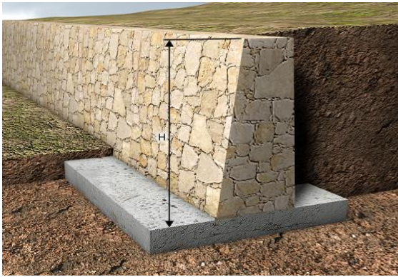
Figura 3.32 – Muro de alvenaria de pedra ( www.geradordepreços.cype.pt ).
