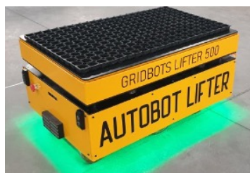
Figura 2.20: GRIBOT LIFTER com luz de advertência a indicar o seu estado de operação [13].
