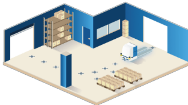
Figura 2.15: Percurso de AGV com instalação de pontos magnéticos [8].
