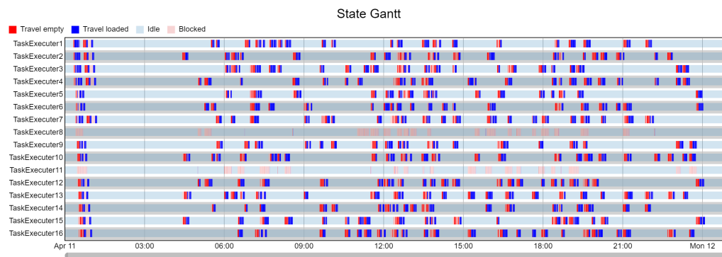
Figura 7.20: Gráfico de Gantt para 16 AGV em funcionamento ao longo do dia.
