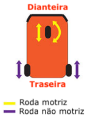
Figura 2.8: Configuração de rodas em triciclo [3].
