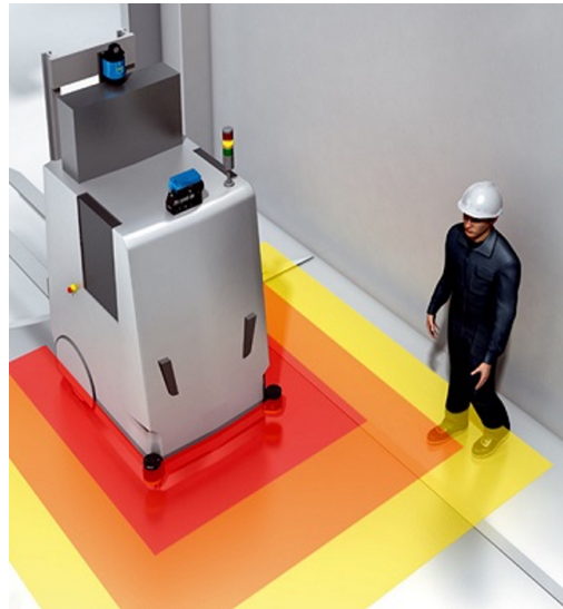
Figura 2.17: AGV que deteta um operador no campo de alerta, representado na zona a amarelo [10].
