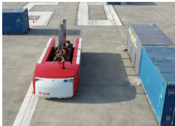
Figura 3.1: MAX, AGV de transporte em fundições de alumínio [14].
