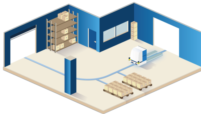
Figura 2.14: Instalação de navegação do AGV por linha magnética [8].
