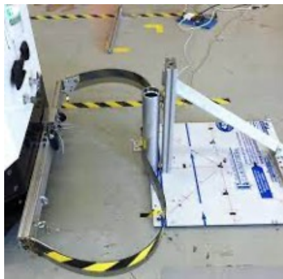
Figura 2.18: Pára-choques de AGV em contacto com uma peça de ensaio vertical [11].
