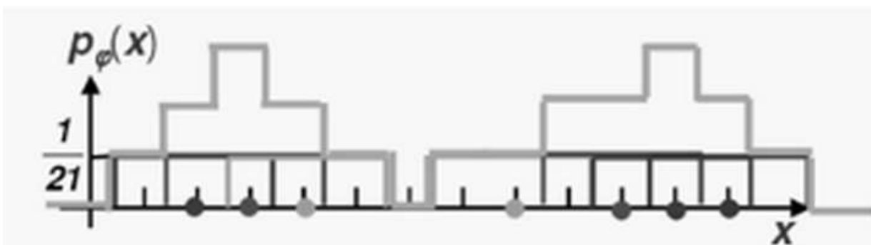
Figura 3.9: Estimativa da função densidade por janela de Parzen do exemplo, modificado de Menotti (2010).
