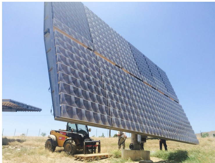
Figura 2.11: Sistema de concentração fotovoltaica, [29]
