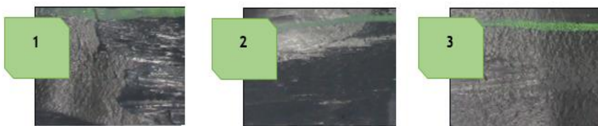
Figura 4.19. Diferentes rugosidades nas amostras de composto B00163.
