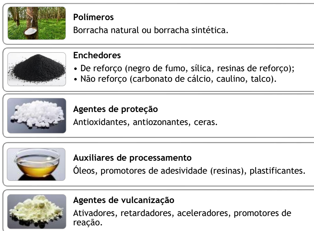
Figura 2.3. Materiais constituintes do pneu.
