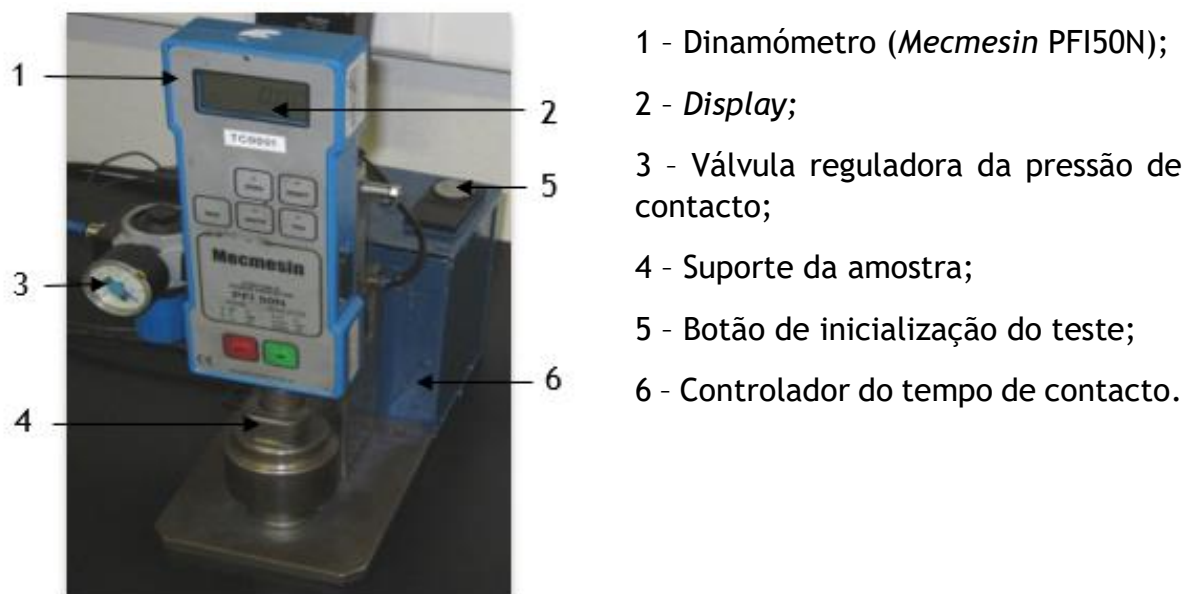
Figura 3.7. Equipamento de medição de adesividade.
