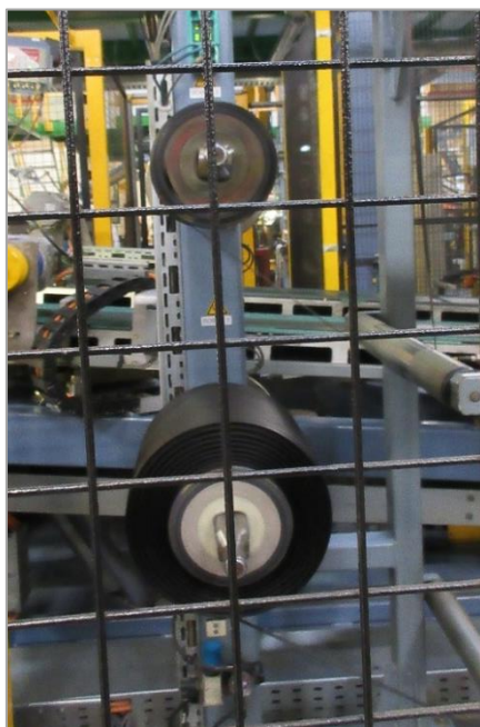
Figura 2.17. Desbobinar da cinta têxtil na fase de construção.
