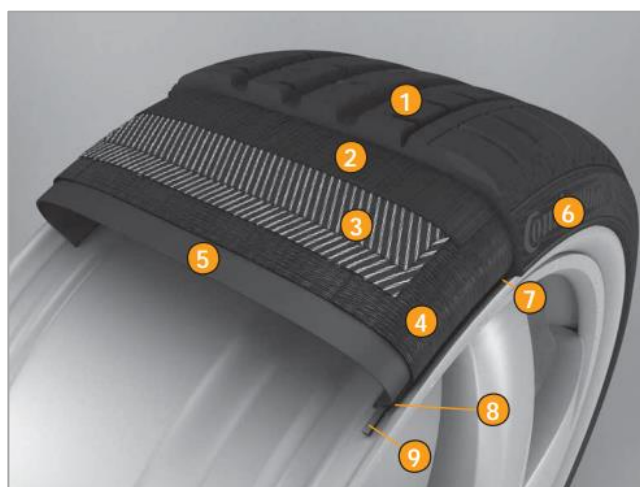
Figura 2.1. Estrutura de um pneu para carro de passageiros. [34]
