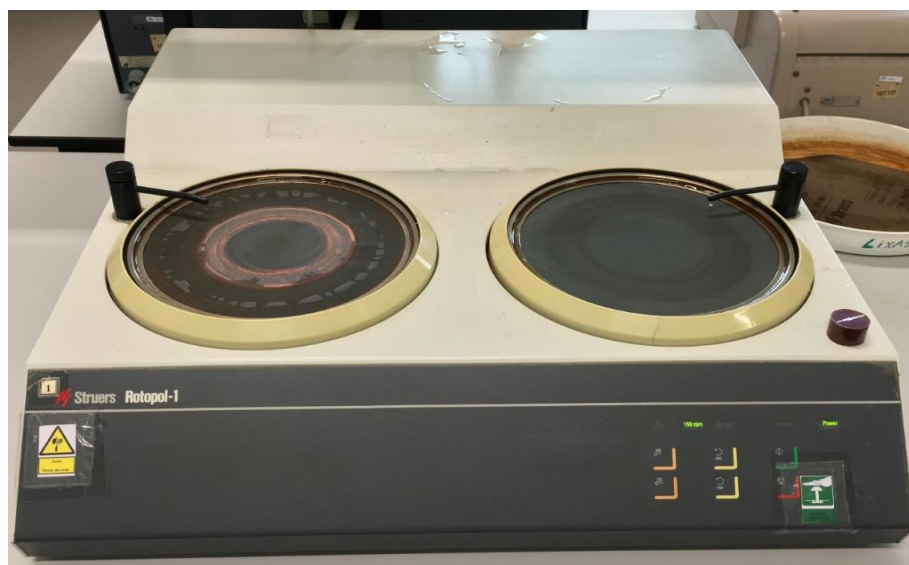
Figura 60 – Lixadeira STRUERS ROTOPOL 1 utilizada para retirar as imperfeições das amostras.
