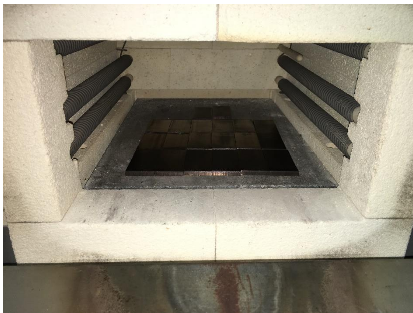
Figura 47 – Provetes sendo aquecidos na mufla a 300 °C, antes da deposição de níquel.
