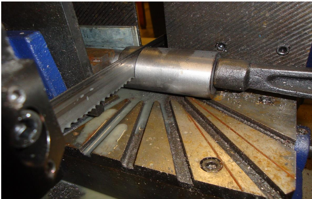
Figura 36 – Realização de um segundo corte no tarugo e obtenção de um novo cilindro com 61 mm de comprimento e 35 mm de diâmetro.
