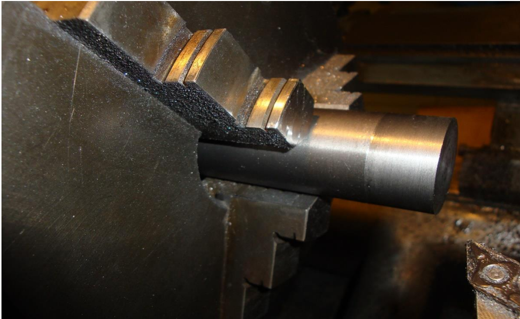
Figura 35 – Provete após o torneamento para a retirada de material, deixando o tarugo com 35 mm de diâmetro.
