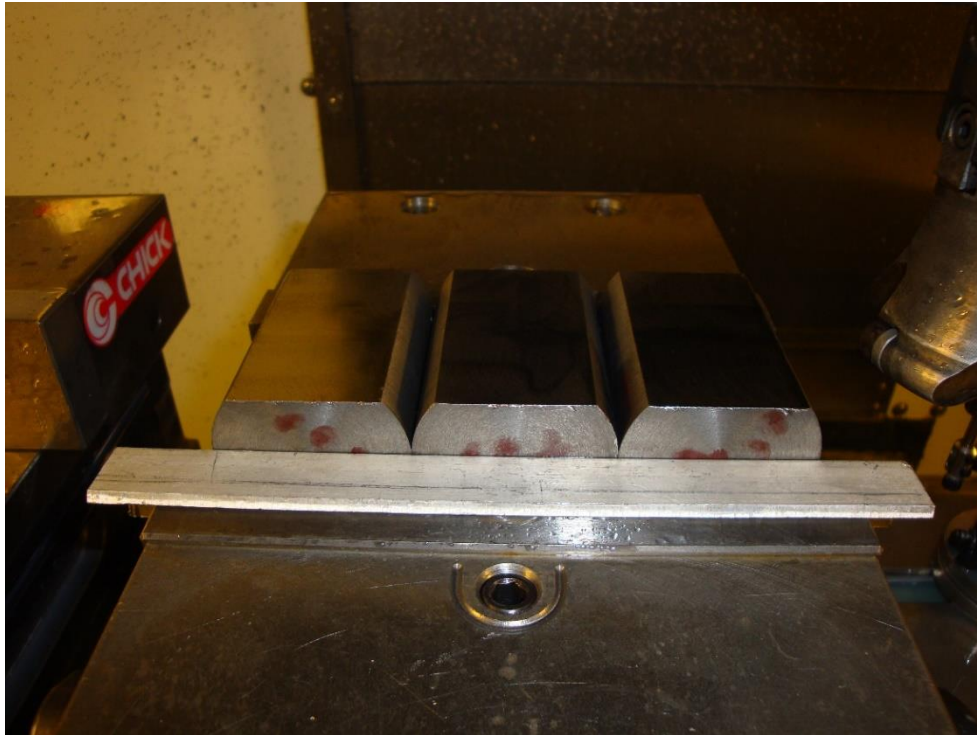
Figura 38 - Faceamento dos cilindros, retirando o material necessário para agregar a dimensão necessário na largura, 30 mm.
