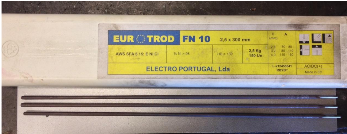
Figura 48 – Elétrodos de níquel FN 10 utilizados na primeira deposição.
