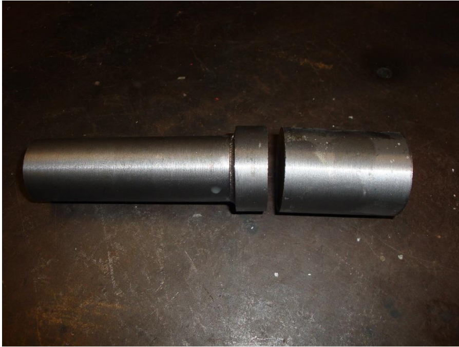
Figura 33 – Provete após o primeiro corte.
