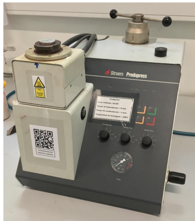
Figura 58 – Prensa STRUERS PREDOPRESS utilizada para embutir as amostras em resina.
