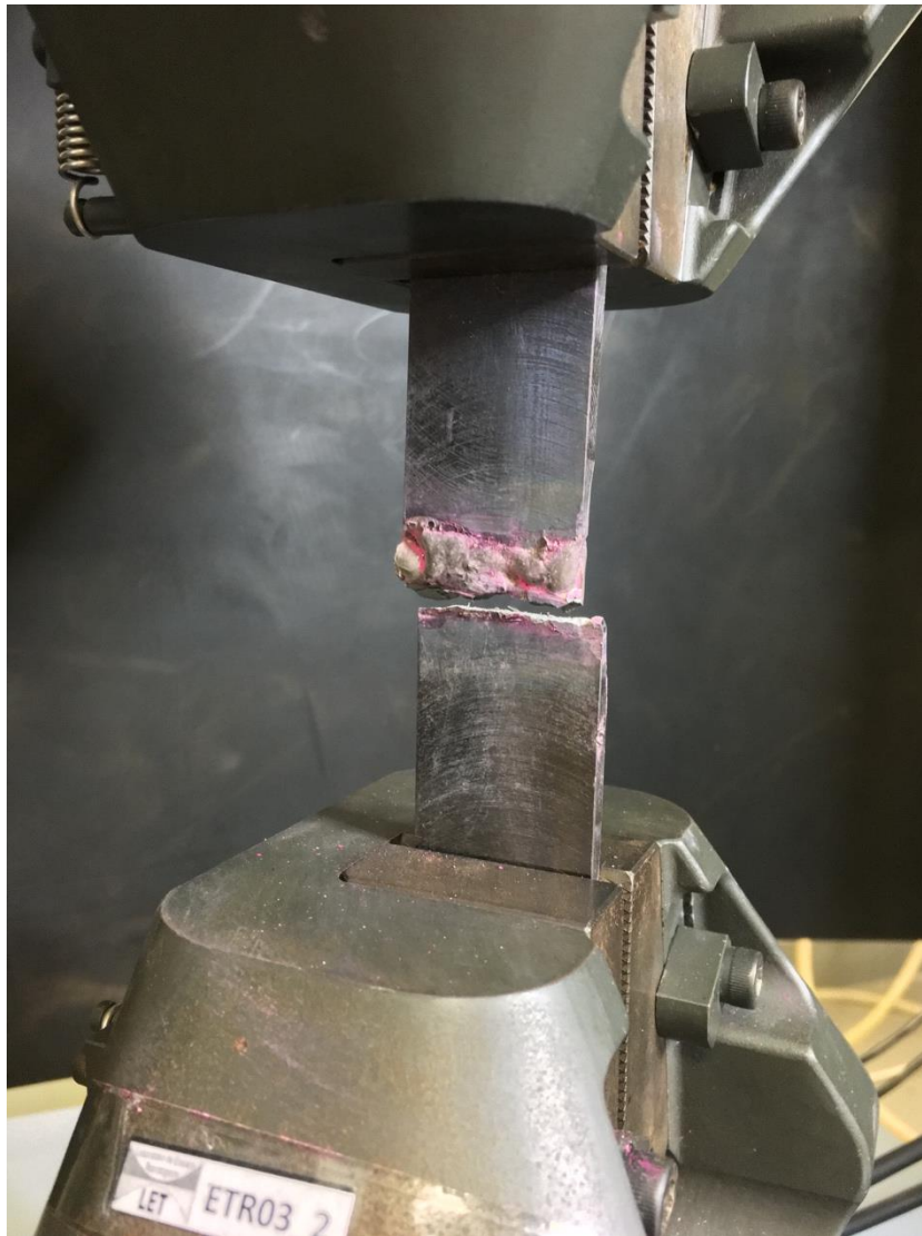
Figura 56 – Amostra após ensaio de tração, evidenciando a fratura na região da ZTA.
