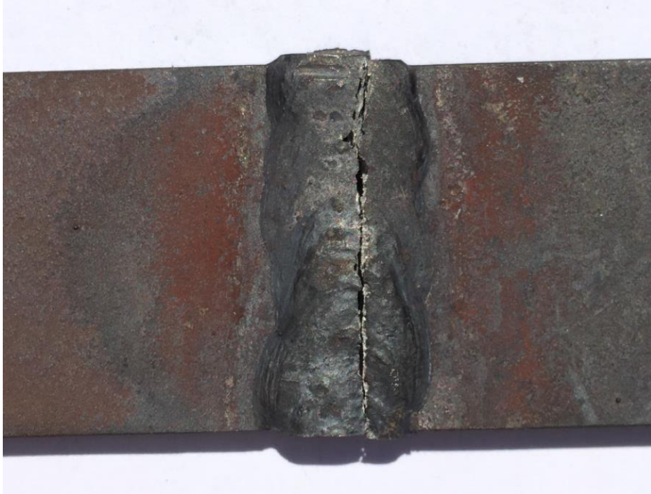
Figura 76 – Local de ruptura da amostra 05_PO_W2_P700.
