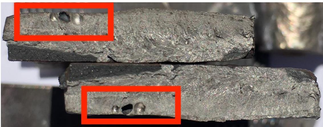
Figura 77 – Presença de poros no interior do cordão de solda da amostra 05_PO_W2_P700.
