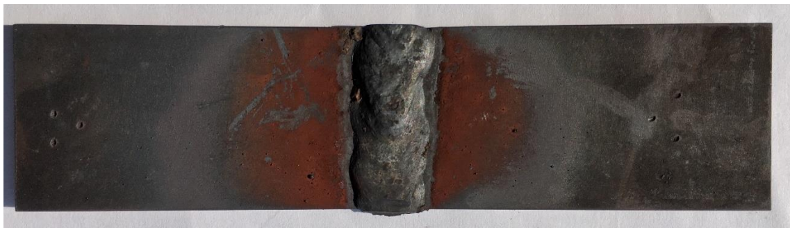
Figura 73 – Inspeção visual da região de solda do Sibodur® 450 com boa qualidade.
