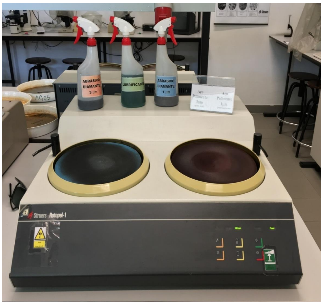
Figura 61 – Polimento das amostras na STRUERS ROTOPOL 1 . Primeiro a amostra foi polida no lado esquerdo na imagem (pano azul) onde se utilizou abrasivo de diamante com granulometria de 3 \mu\text{m} . Após esse procedimento, poliu-se a amostra com abrasivo de diamante com granulometria de 1 \mu\text{m} , no lado direito (pano vermelho).
