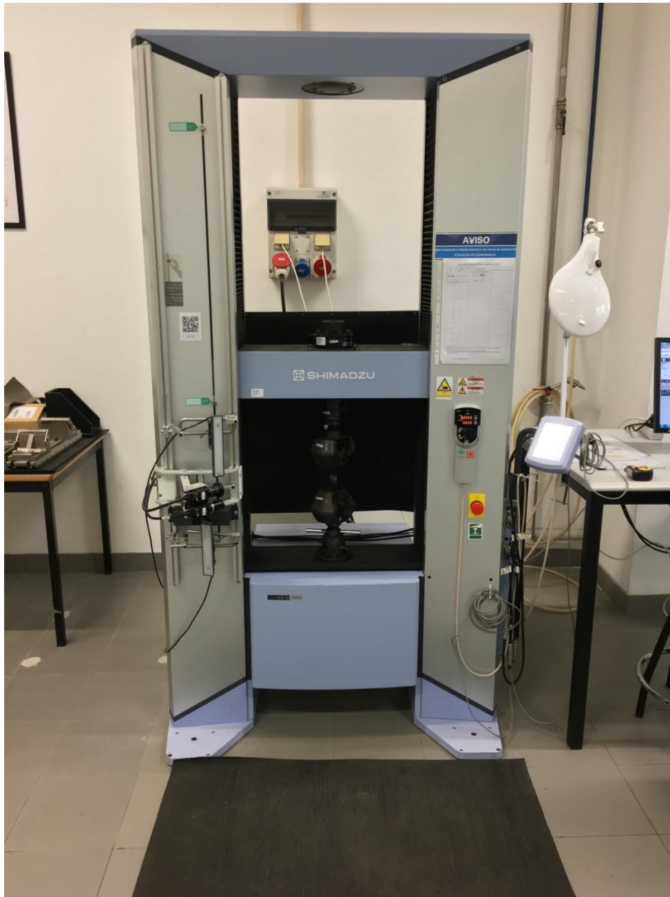
Figura 54 – Equipamento Shimadzu Autograph AGS-X – 100 kN utilizado no ensaio de tração.
