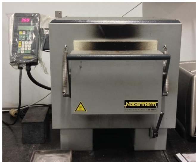
Figura 45 – Mufla Nabertherm N 11/H na qual foi feito o aquecimento dos provetes antes da deposição de níquel e antes da soldagem definitiva
