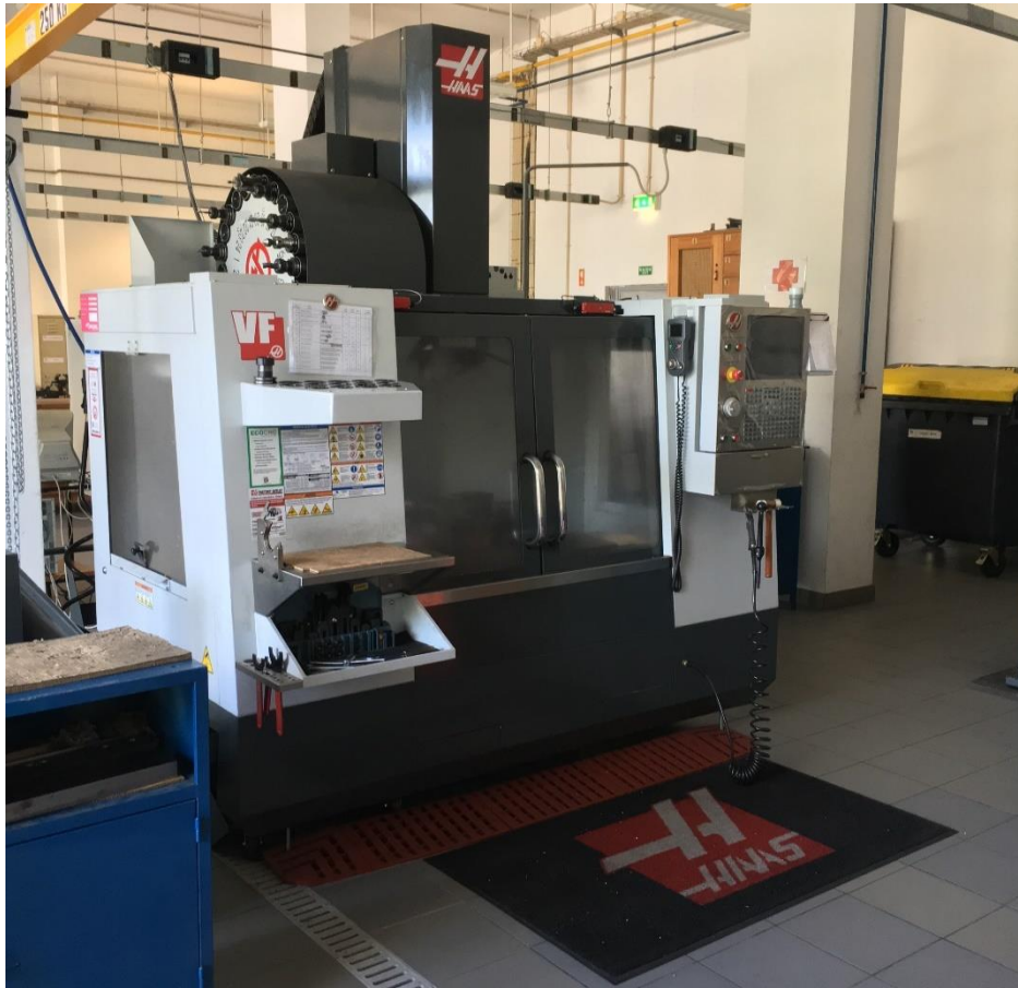
Figura 37 – Centro de usinagem CNC HAAS VF-2.
