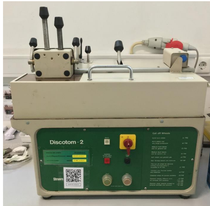
Figura 57 – Equipamento DISCOTOM 2 utilizado para o corte das amostras através de disco rotativo.
