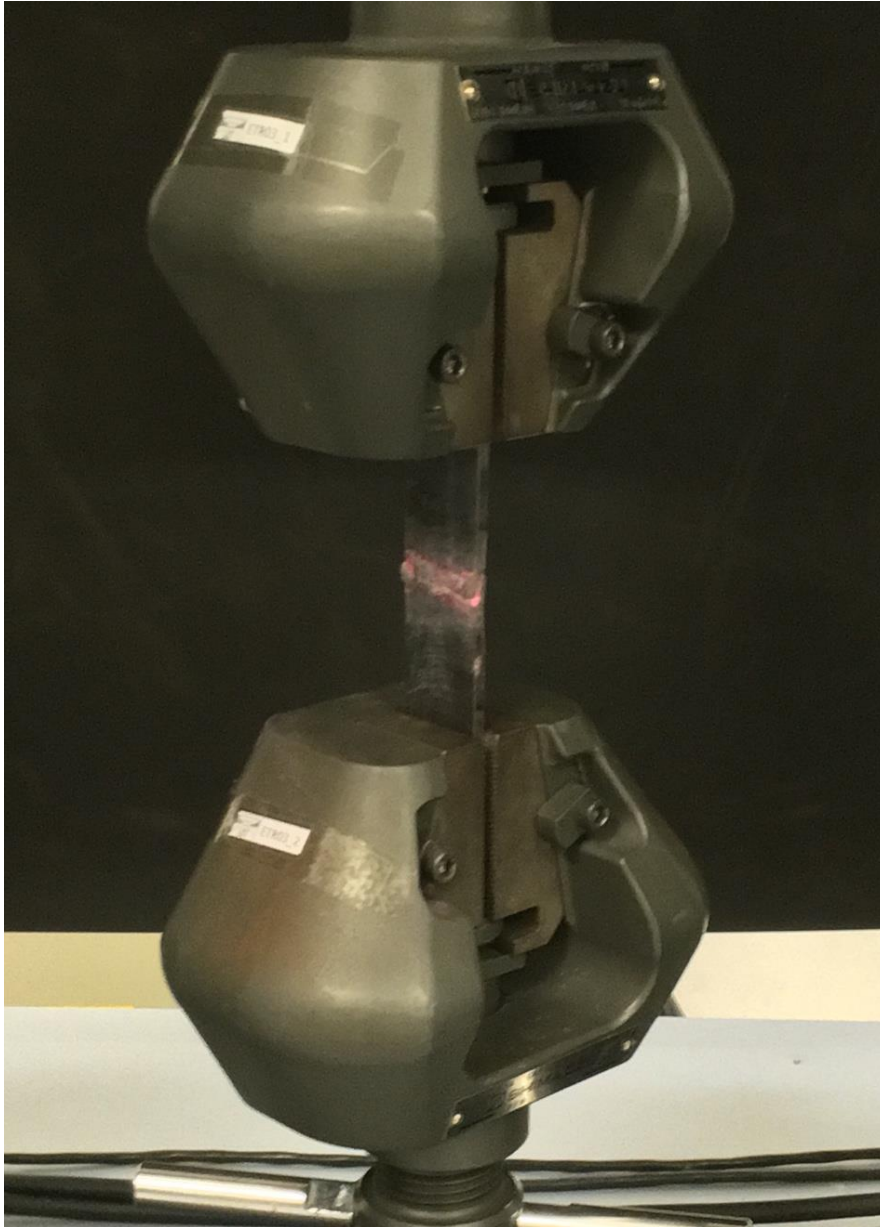
Figura 55 – Fixação da amostra para início do ensaio de tração, com distância entre garras de 85 mm.
