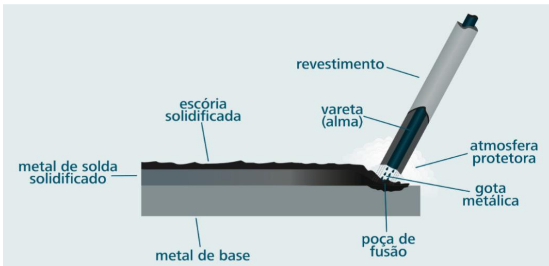
Figura 23 – Esquema da soldagem por eletrodo revestido [45].
