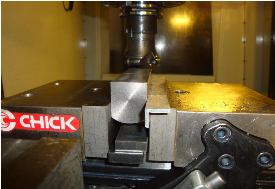
Figura 40 – Faceamento no material para tirar as possíveis irregularidades causadas pelo corte anterior.
