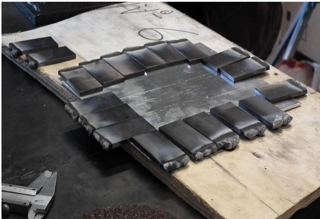
Figura 49 – SidoDur® 450 após deposição de níquel e ainda com escória deixada pelo processo.
