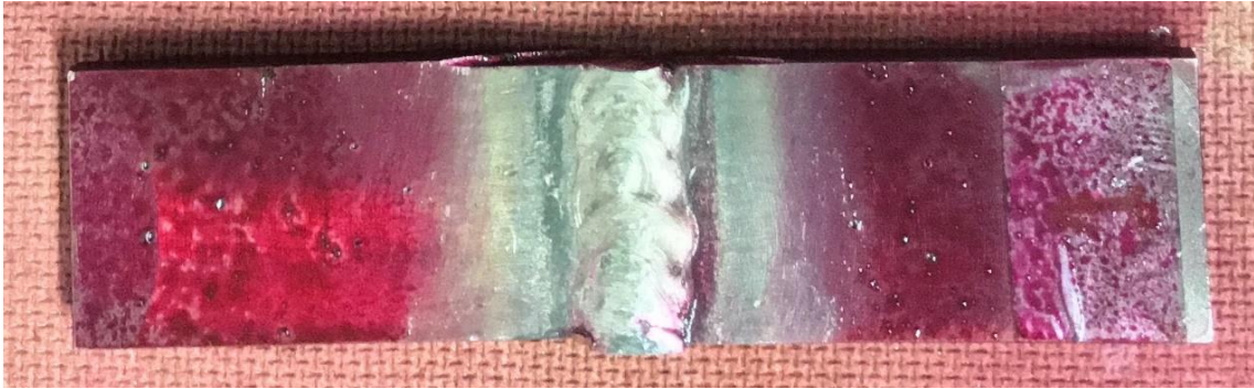
Figura 69 – Amostra após a retirada do excesso de líquido penetrante e antes da aplicação do revelador.
