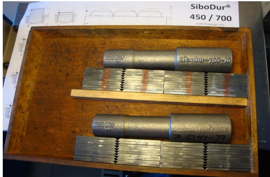
Figura 43 – Provetes obtidos após usinagem do tarugo de Sibodur® recebido.
