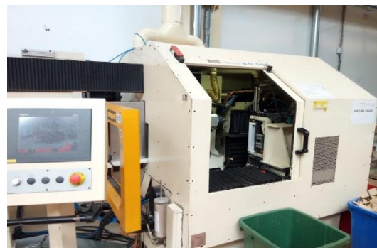
Figura 21 - Centro de corte e maquinagem de calços
