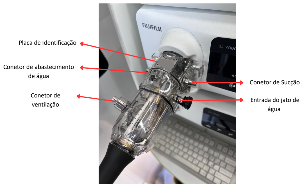
Figura 20 Composição do Connetor
