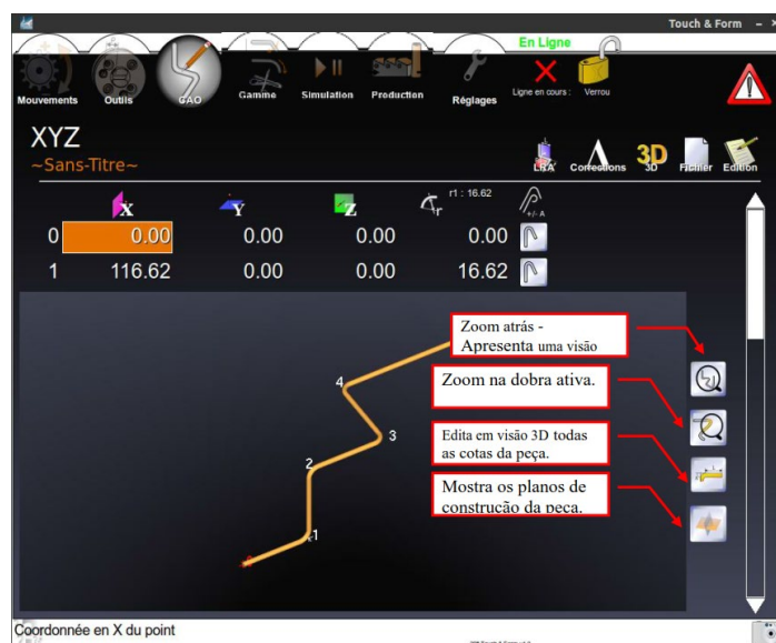
Figura 30 - Vista 3D do arame na consola do equipamento
