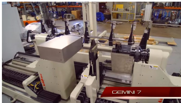
Figura 45 - Equipamento de dobragem Gemini 7
