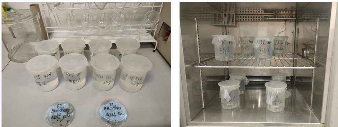
Figura 14 - Soluções de NaCl preparadas para receber as amostras de AISI 304 e AISI 316 (à esquerda) e material de ensaio inserido dentro da estufa (à direita).
