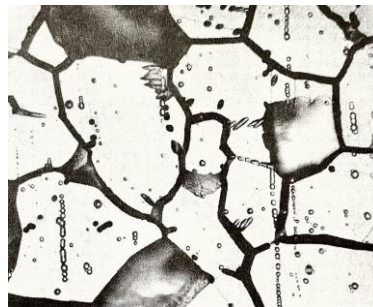
Figura 8 - Fissuras a indicar a presença de ataque intergranular em aço inoxidável [5].
