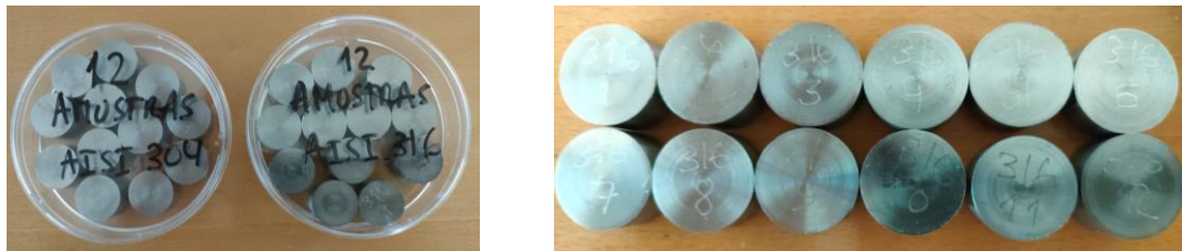
Figura 12 – Agrupamento das doze amostras de cada material (à esquerda) e vista em detalhe dos provetes de AISI 316 identificados (à direita).
