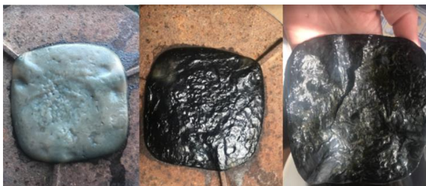
Figura 57 - desidratação sobre ferro não tratado
