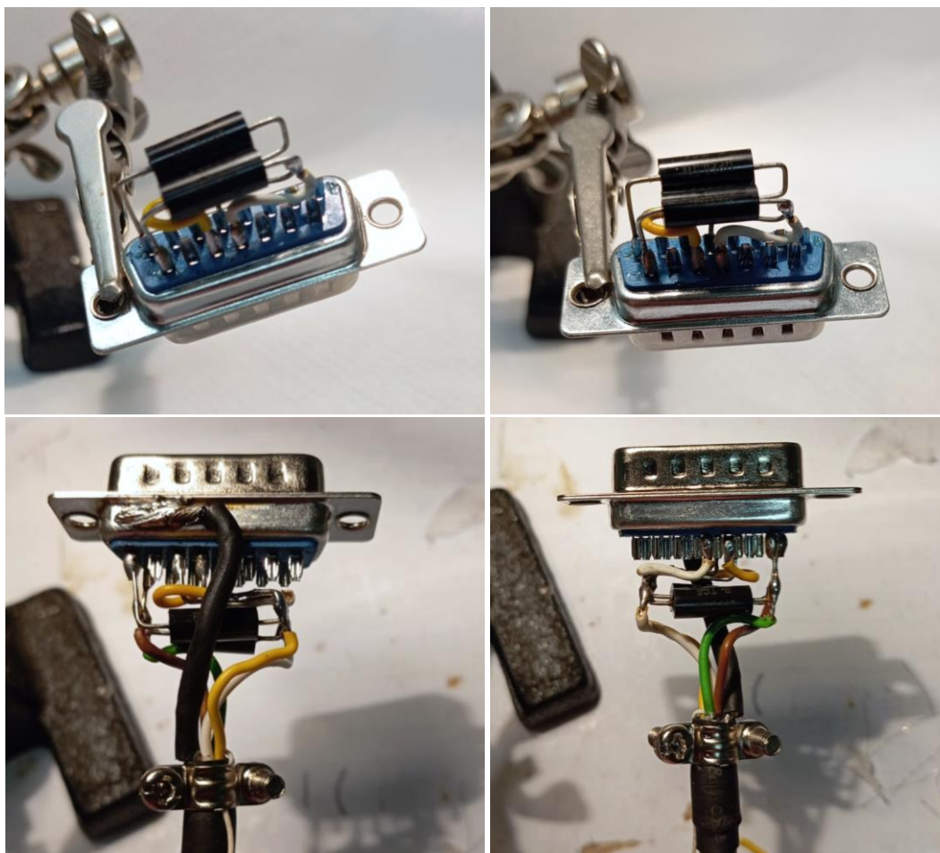
Figura 83 – Montagem das resistências e cabos na ficha de ligação ao equipamento de aquisição
