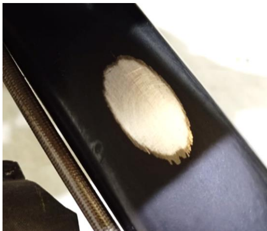
Figura 78 – Preparação da superfície para aplicação de extensómetros
