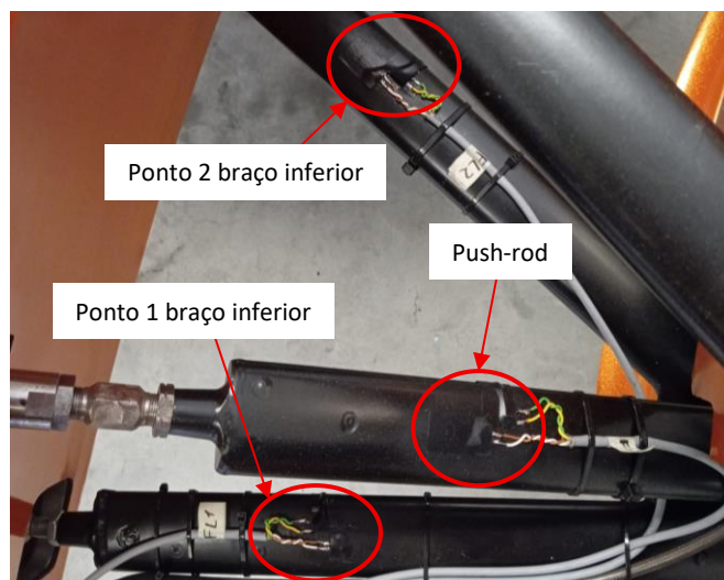
Figura 77 – Suspensão frontal instrumentada e legenda dos pontos de análise
