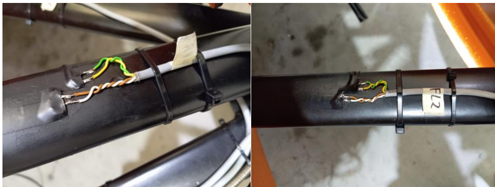
Figura 85 – Aplicação dos cabos de dados aos extensómetros nas peças a estudar
