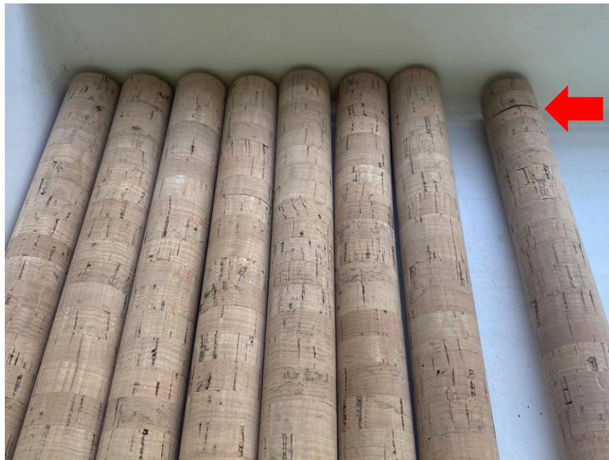
Figura 22 – Operação de escolha de tubos.
