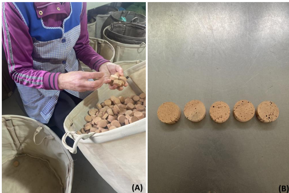
Figura 17 – (A) Operação de escolha dos discos; (B) Discos de diferentes qualidades.
