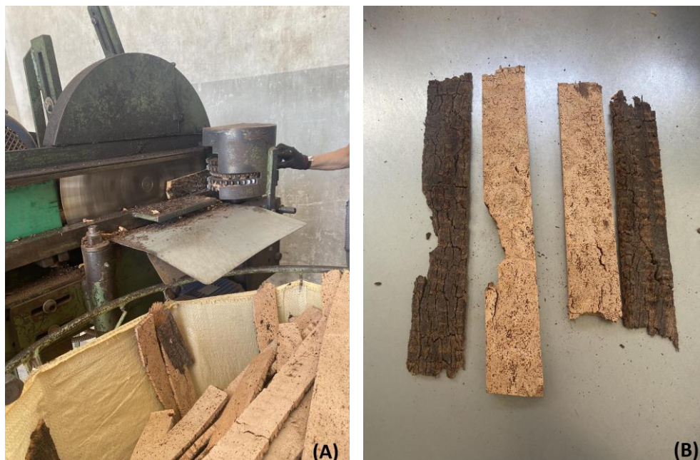
Figura 15 - (A) Operação de Laminagem; (B) Tiras de cortiça sem costa.
