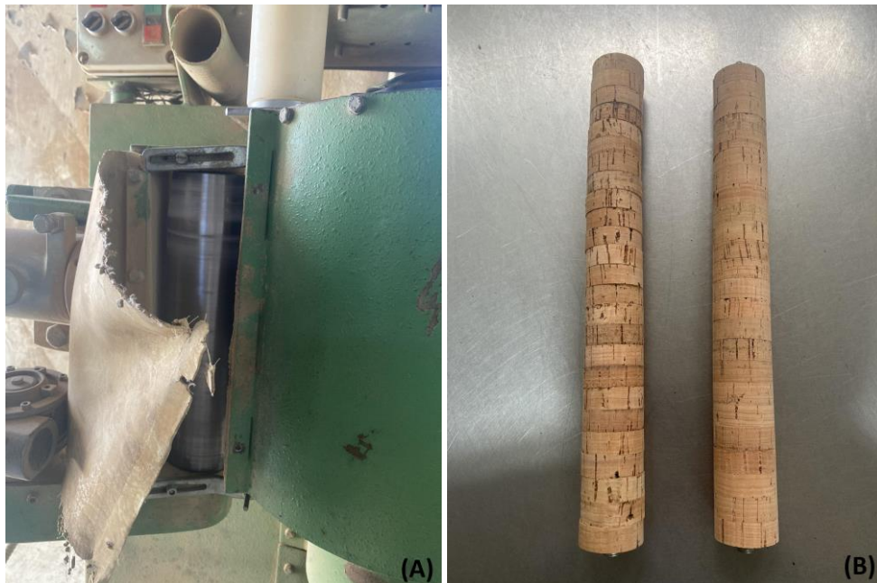
Figura 20 - (A) Ponçadeira; (B) Tubos depois da lixagem lateral.
