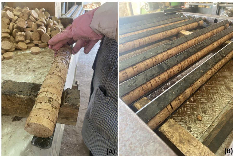
Figura 18 - (A) Colagem dos discos; (B) Tubos na prensa.
