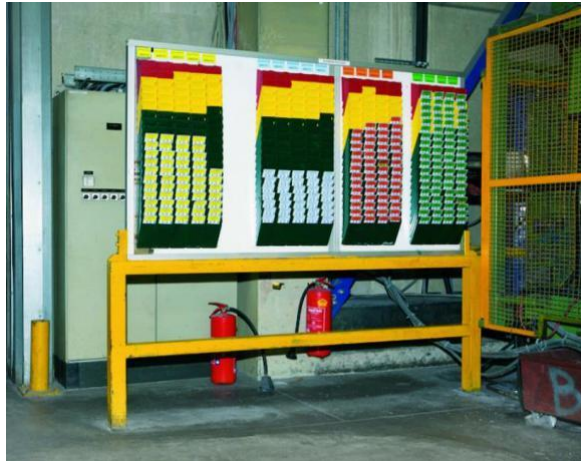
Figura 10 - Representação de um quadro de um sistema Kanban [77].
