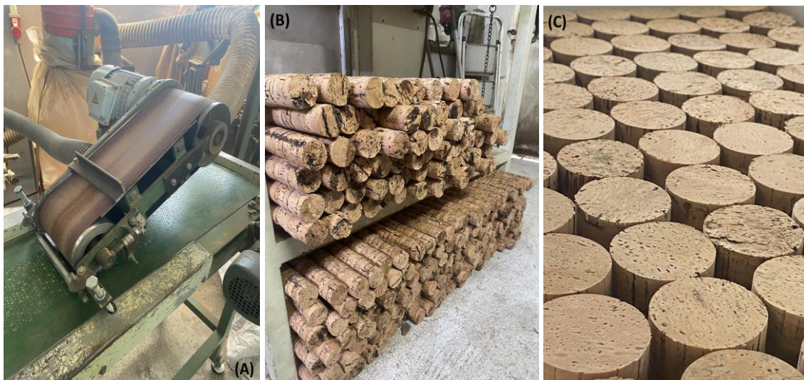
Figura 21 - (A) Lixadeira; (B) Topo não lixados; (C) Topos lixados.
