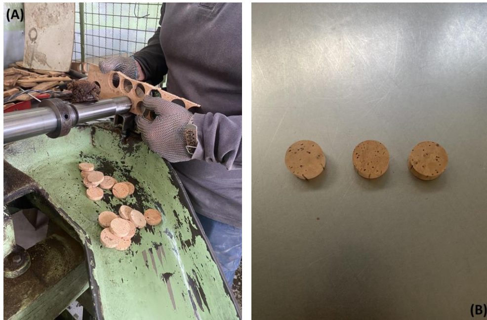
Figura 16 - (A) Operação de furação; (B) Discos de cortiça.
