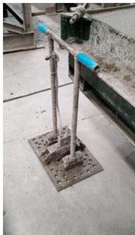
Figura 4-9 – Placa vibratória de compactação para o betão estrutural;
