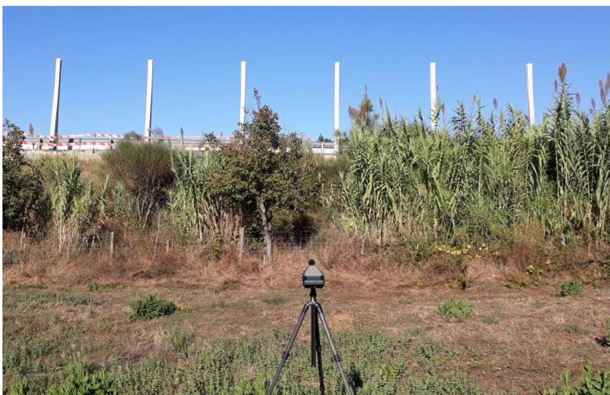
Figura 4-20 – Elaboração de medições antes da aplicação das barreiras acústicas, equipamento recetor – microfone;
