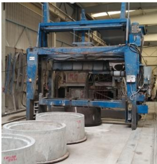
Figura 2-4- Produção de Anéis pré-fabricados através de dispositivo mecânico deslizante;
