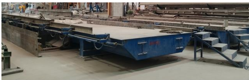
2Figura 2-5- Mesa fixa com vibrador acoplado;
