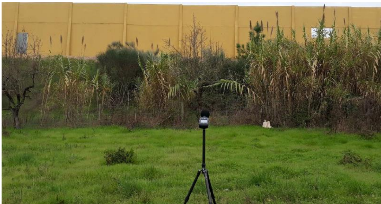
Figura 4-21 -. Elaboração de medições após a aplicação de barreiras acústicas, equipamento recetor - microfone;
