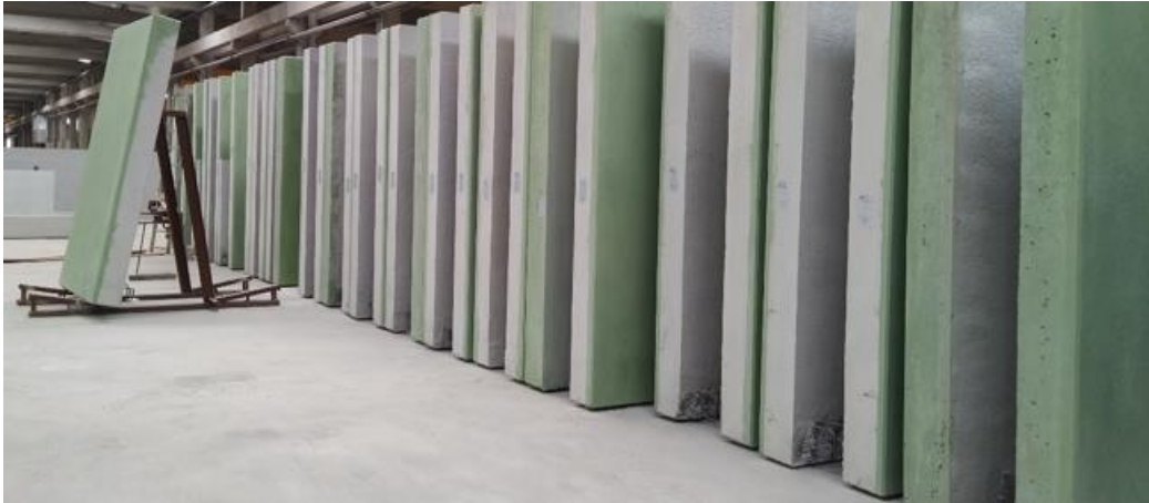
Figura 2-9- Armazenamento de painéis estruturais;
