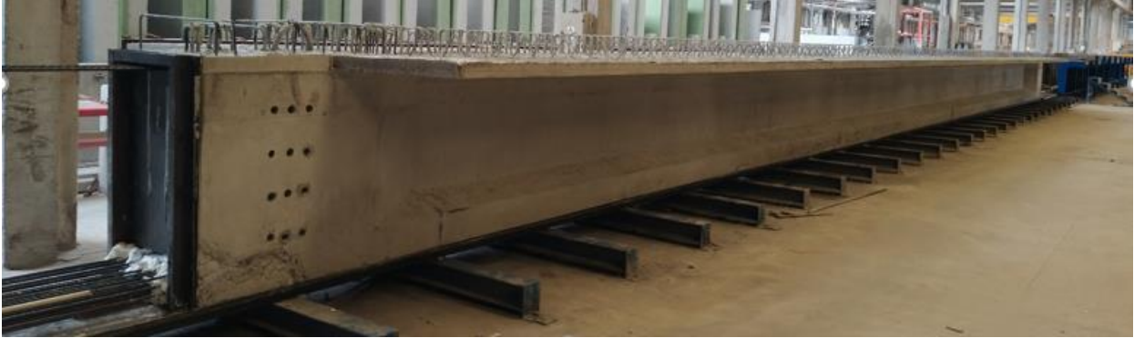
Figura 2-3 – Viga pré-fabricada, aplicação de pré-esforço em pré-tensão;
