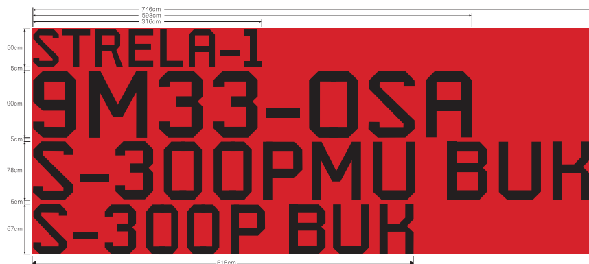
Esquema de colocação do letering na fachada lateral direita do módulo BREAK THE ICE
