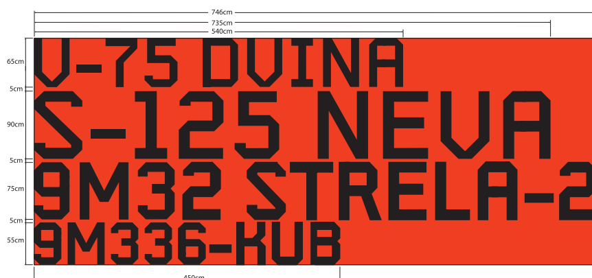
Esquema de colocação do letering na fachada lateral esquerda do módulo BREAK THE ICE
