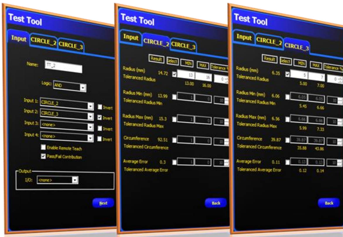
Figura 50 Comando Test Tool para definir os intervalos de aceitação
