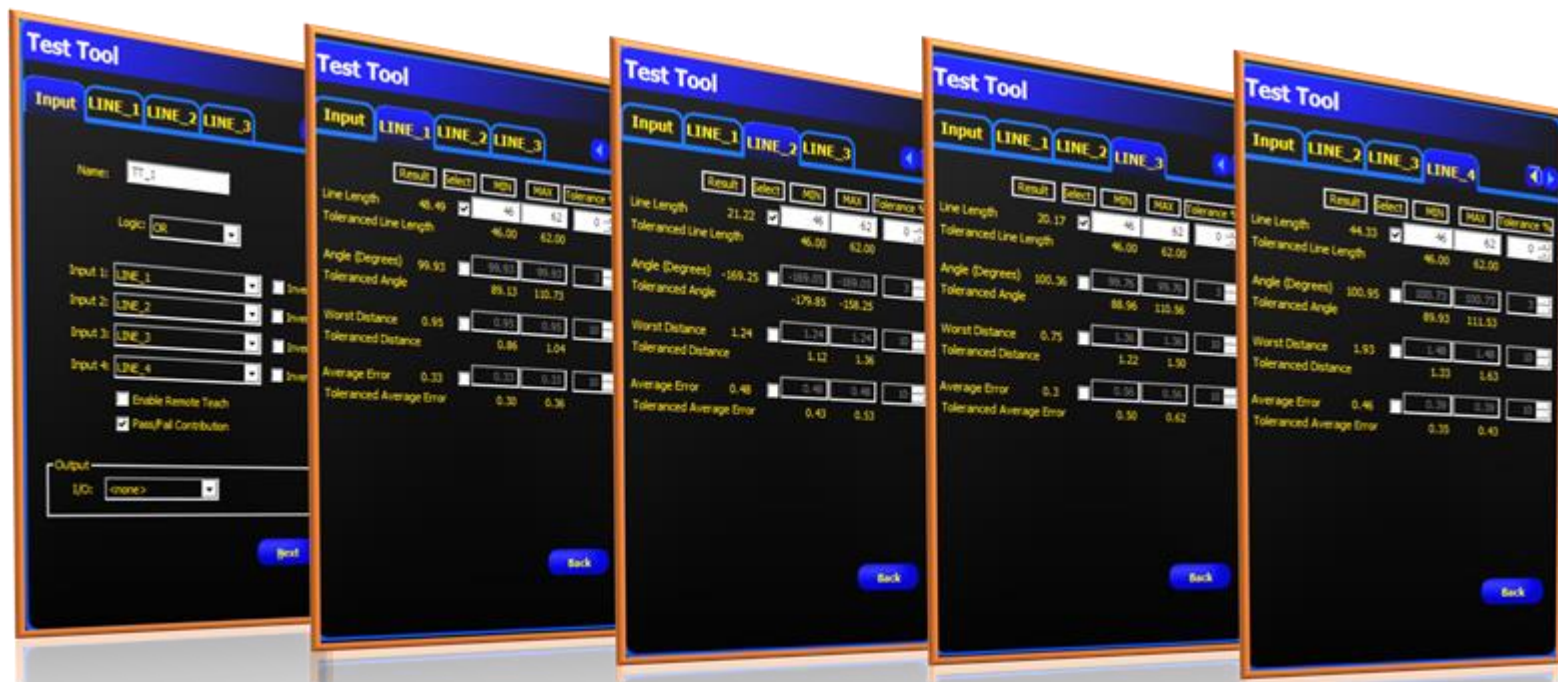
Figura 58 Comando Test Tool para definir intervalo de aceitação do tamanho do corpo do parafuso
