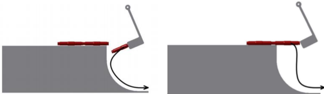
Figura 65 Rotação de 180 de peça mal orientada (esquerda), Queda de peça bem orientada, sem sofrer mudança de orientação. (direita) [63]
