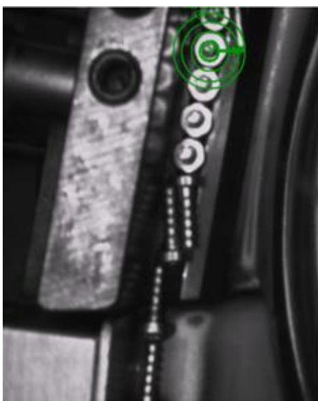
Figura 72 Resultado obtido pelo programa “Deteção das cabeças”
