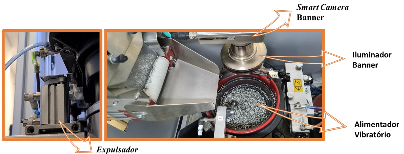
Figura 33 Equipamentos usados no projeto
