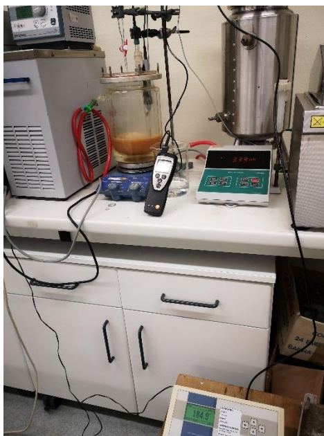
Figura 4.5. Instalação utilizada para os ensaios com reagente de Fenton.
