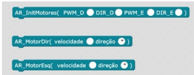
Figura 4.35: Blocos de código para controlo dos motores no mBlock.
