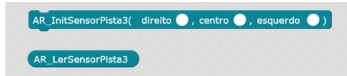
Figura 4.37: Blocos mBlock para obtenção dos valores do módulo de detecção de linha.
