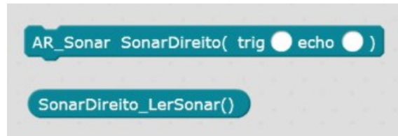
Figura 4.42: Blocos mBlock para leitura dos sensores ultrassonicos.
