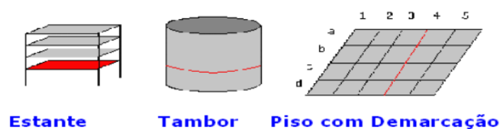
Figura 21 - Indicação de níveis mínimos de Stock e a demarcação do Layout no chão
