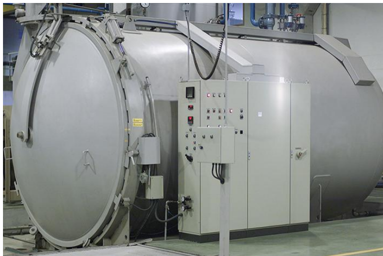
Figura 9 - Autoclave para vidro Laminado
