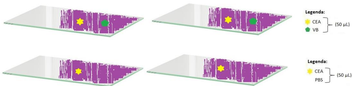
Figura 2.4. Vidros PANI com solução de proteína com (topo) ou sem (em baixo) monómero carregado positivamente (VB).
