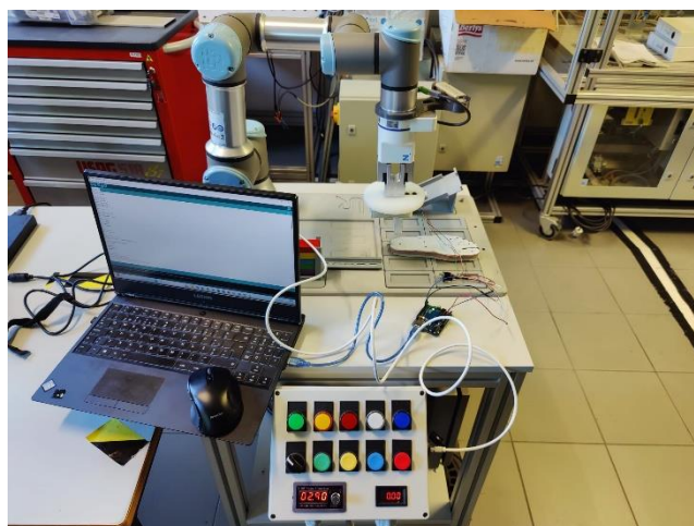
Figura 40 – Ligações entre o computador e caixa de controlo do robô e acoplamento do end-effector ao braço robótico
