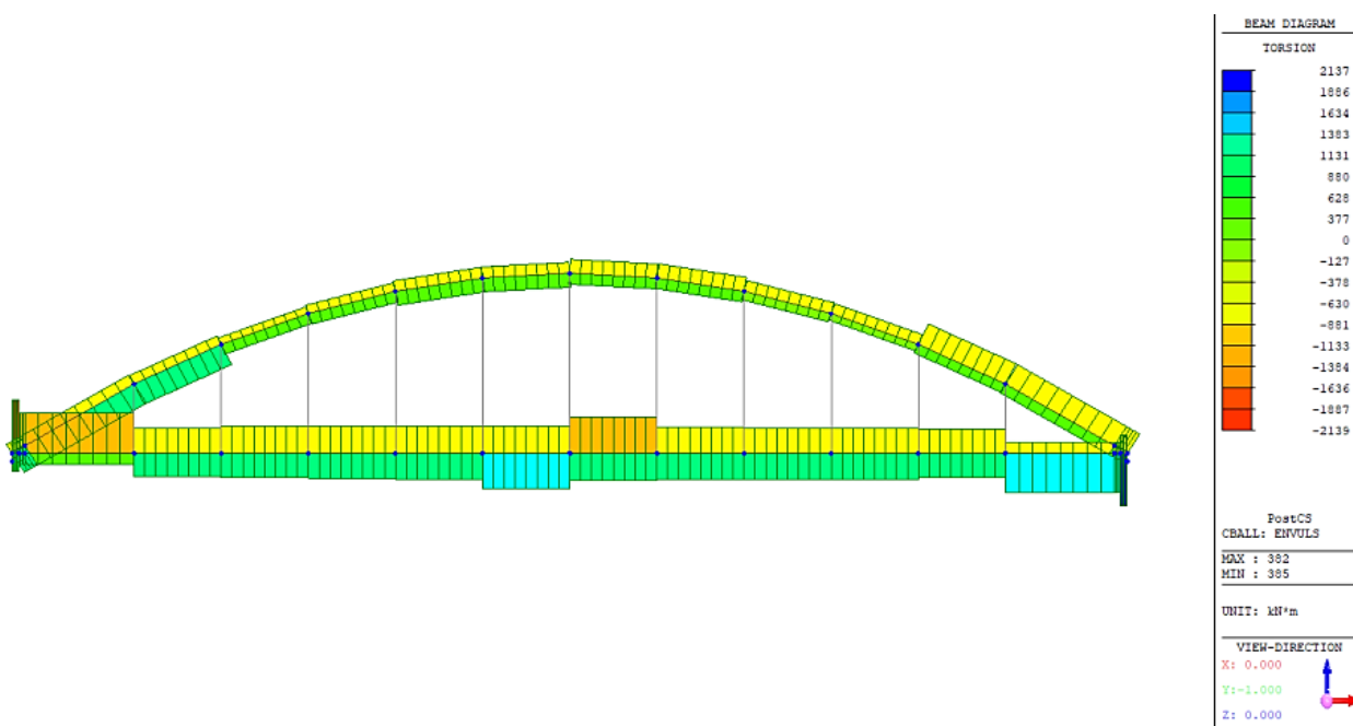
Figura 4.29 – Momentos de torção Mx (Envelope (+-) – ULS)
