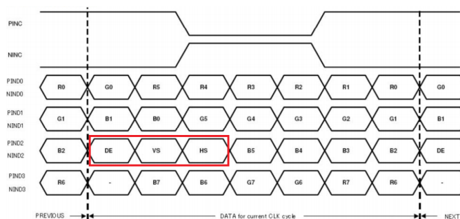
Figura 2.8: Interface LVDS entre um display e microcontrolador. [4]
