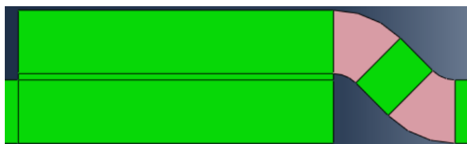
Figura 153 - Malha estruturada do adesivo formada por quadriláteros coincidentes com as direções ortogonais, em concordância com as áreas retangulares definidas pelas partições nos aderentes (modelo para obtenção de tensões).
