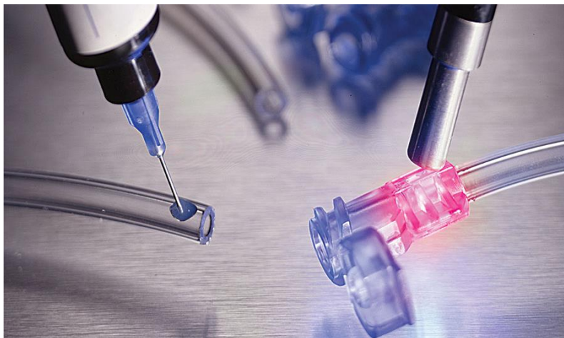
Figura 11 - União e montagem de cateteres à base de Nylon e de PEBA com um adesivo curável por LED [136].
