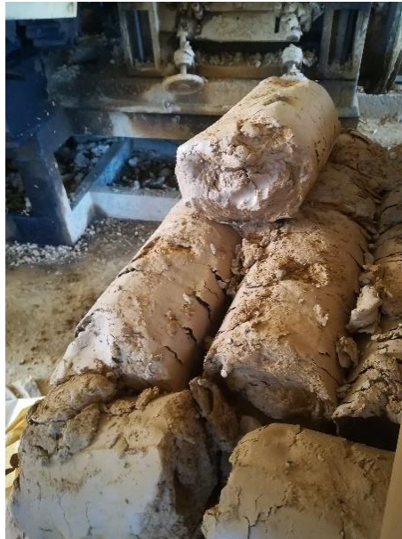
Figura 151 – Cilindros de barro apenas misturados (Cerâmica Soutelo)
