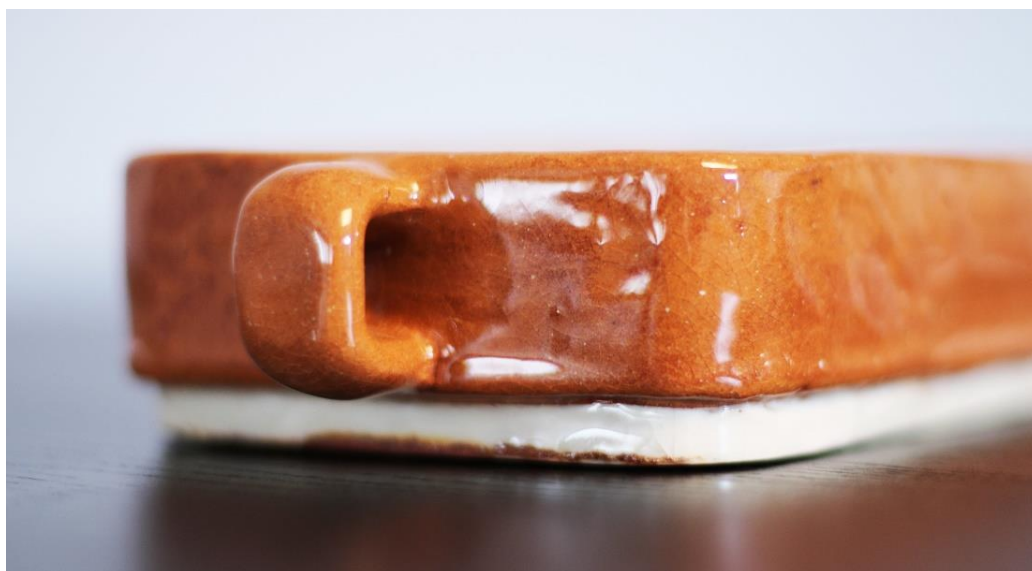
Figura 178 - Deformidades na base do assador
