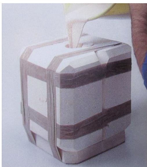
Figura 47 - Barbotina de enchimento vertida para o interior de um molde através da boca de enchimento
