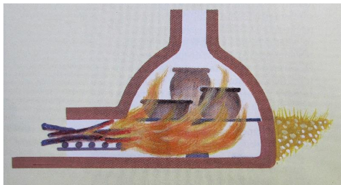
Figura 53 - Ilustração de um forno a lenha de chama ascendente
