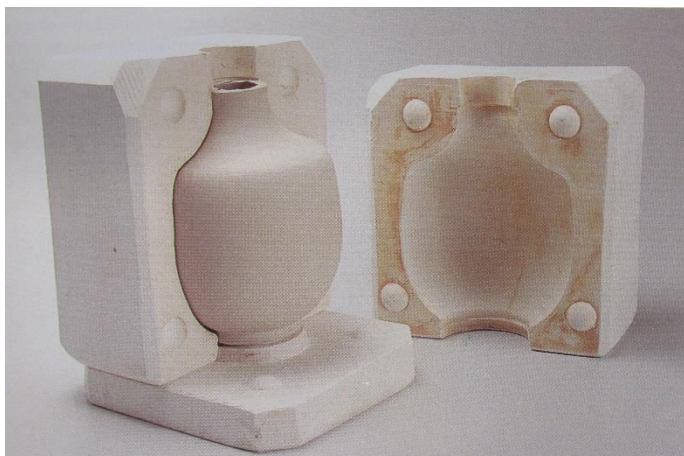
Figura 49 - Abertura do molde
