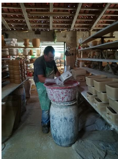
Figura 65 - Calda de vidragem aplicada por mergulho (Adelino Soutelo - Cerâmica Soutelo, Barcelos)
