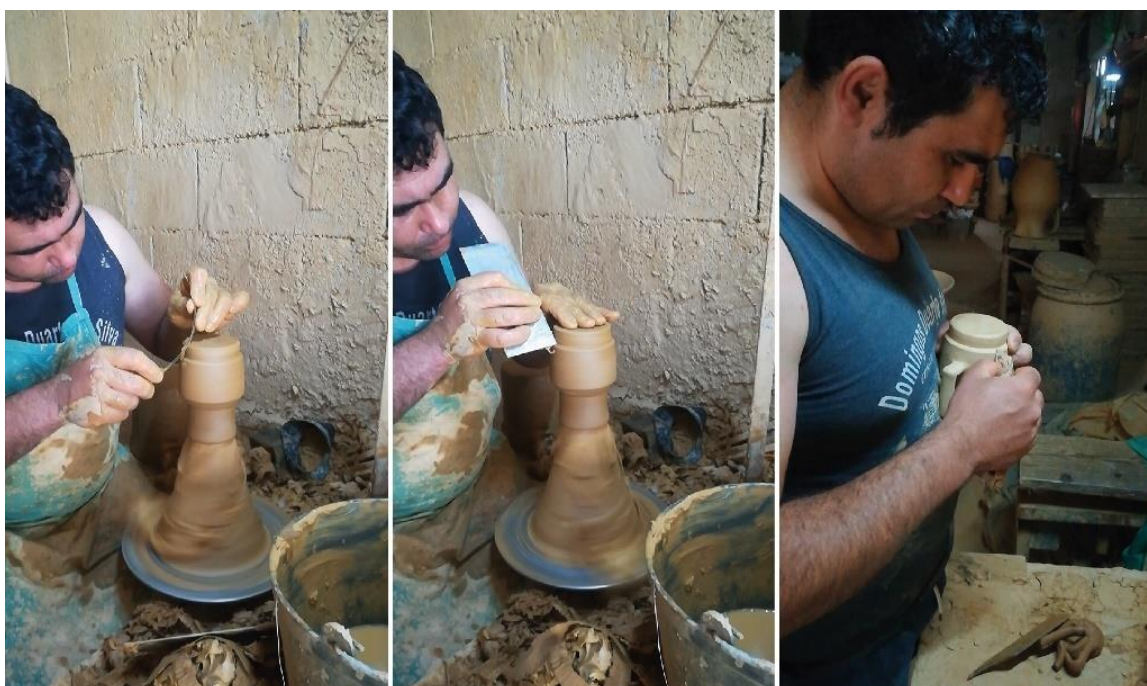
Figura 168 – Realização dos cortes biselados na caneca (Cerâmica Soutelo)
