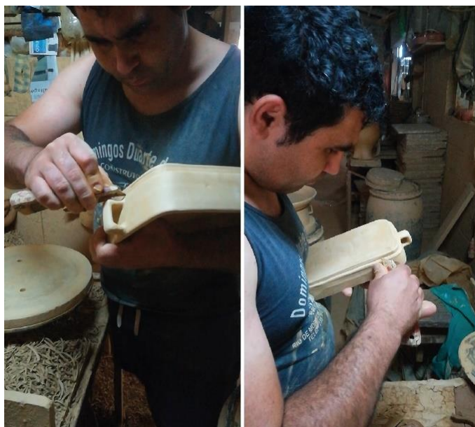
Figura 169 - Realização dos cortes biselados na assadeira e no assador (Cerâmica Soutelo)
