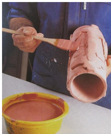
Figura 64 - Aplicação da calda de vidragem com pincel
