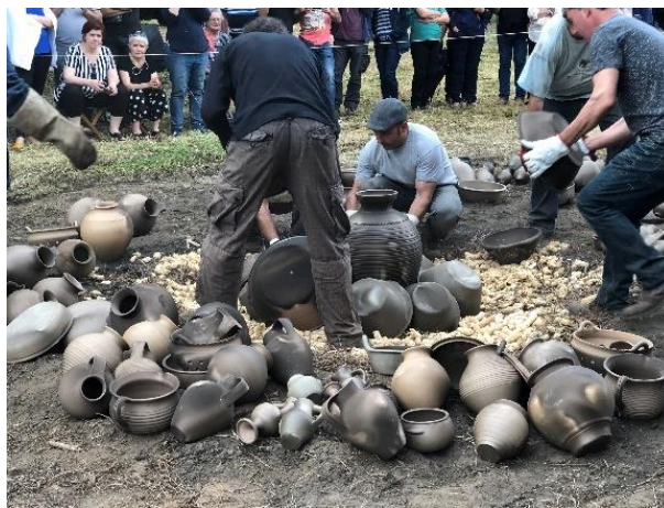
Figura 13 - Método tradicional de cozer louça de barro preto, em Molelos
