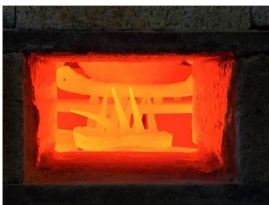
Fonte: (The Potters' Studio, n.d., acessado em: 2018/06/15, disponível em: https://www.berkeleypottersstudio.com/firing-services/ ) Figura 57 - Cones pirométricos em utilização no interior de um forno
