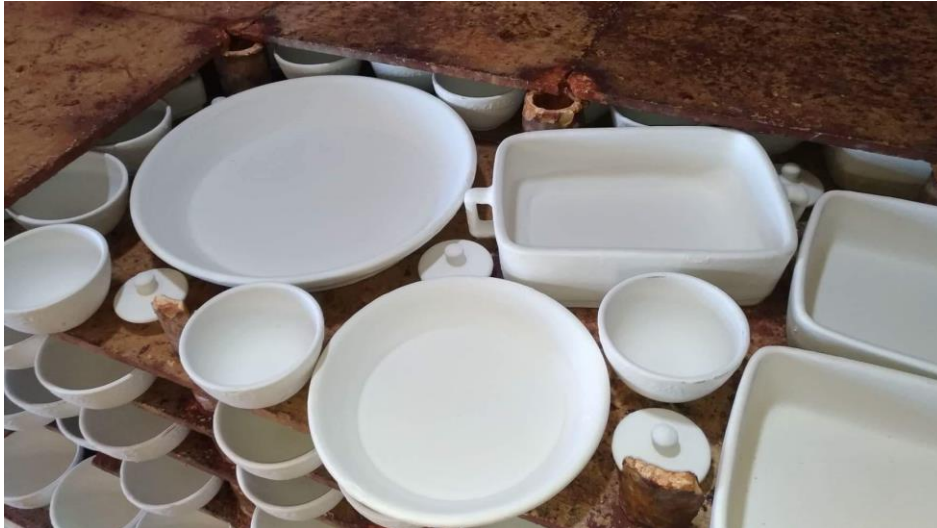
Figura 174 – Ladeira, prato, e assadeira em fase de enformamento (Cerâmica Soutelo)
