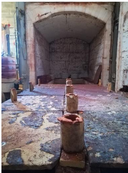
Figura 59 - Suportes de enforma (Cerâmica Soutelo, Barcelos)
