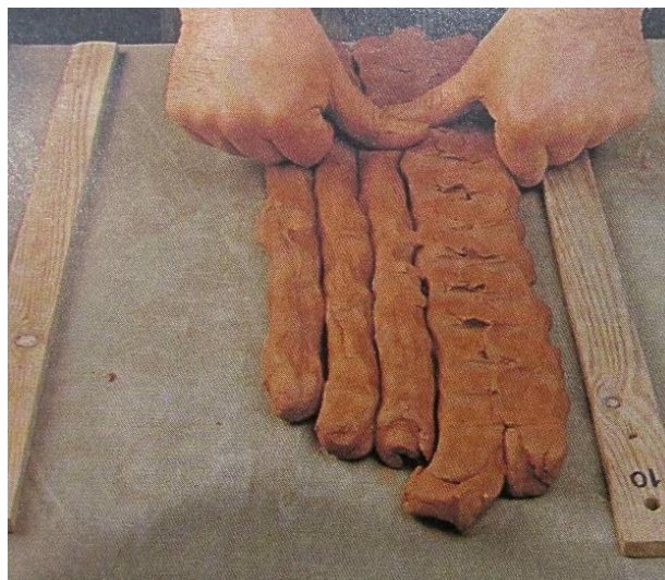
Figura 39 - União dos rolos sob ação dos polegares
