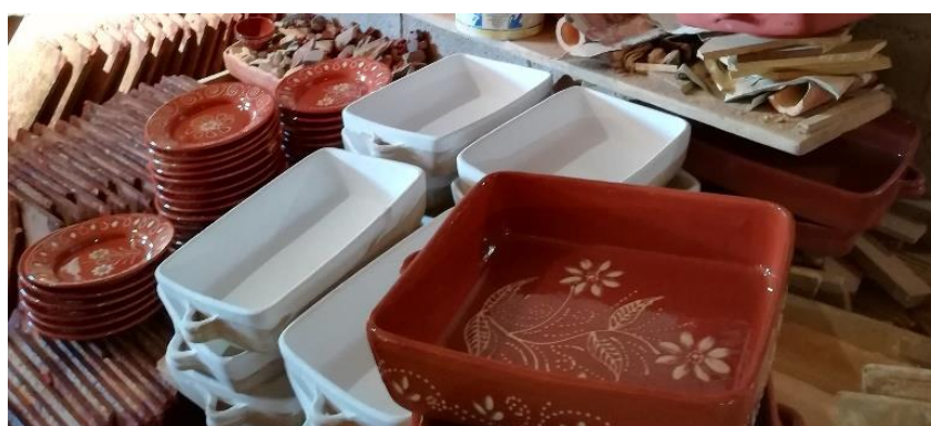
Figura 63 - Calda de vidragem seca – peças brancas (Cerâmica Soutelo, Barcelos)
