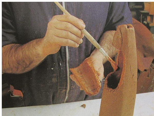
Figura 44 - União das partes a colar com recurso a barbotina
