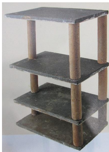
Figura 60 – Fixação das prateleiras de enforma em três pontos
