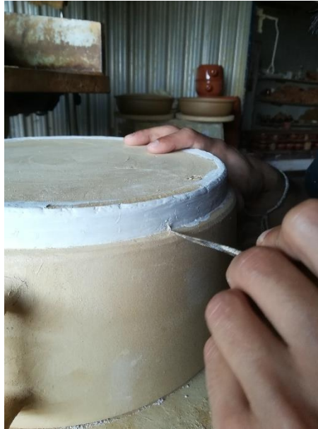
Figura 173 - Fase de raspagem do excesso de barro branco (Cerâmica Soutelo)
