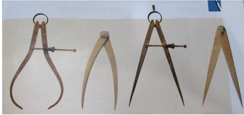
Figura 28 - Dois compassos redondos e dois retos (da esquerda para a direita)
