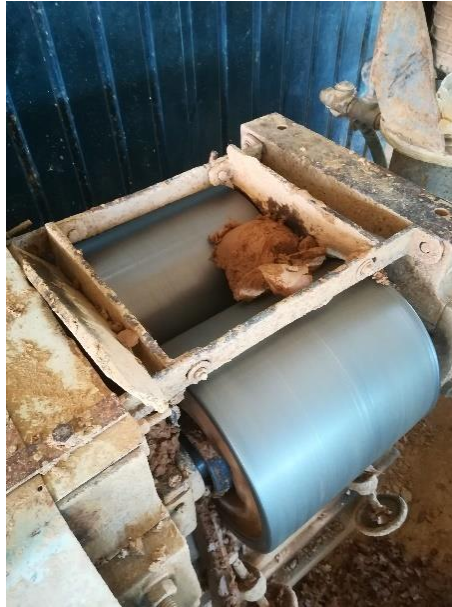
Figura 152 – Máquinas de cilindros com vácuo (Cerâmica Soutelo)
