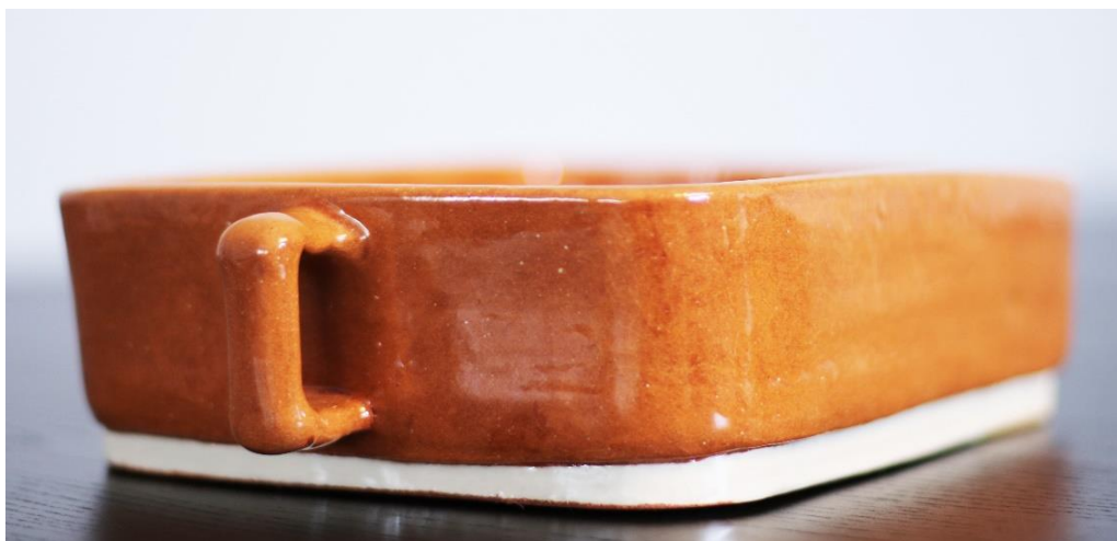
Figura 177 - Deformidades na base da assadeira
