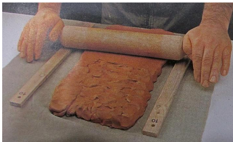
Figura 40 - Uniformização da placa
