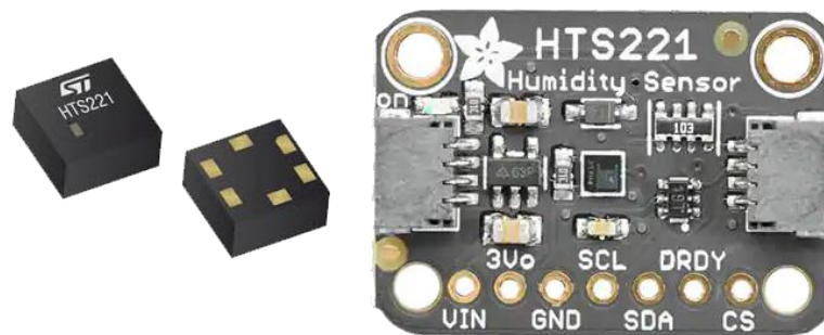
Figura 44 Sensor de Temperatura e Humidade HTS221
