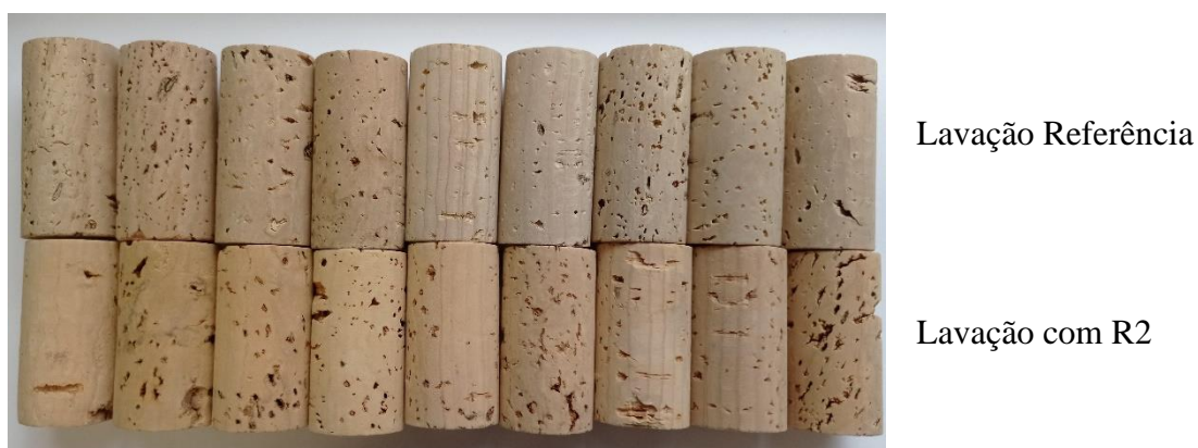
Figura 6. 10. Comparação entre a cor da lavação referência e a cor obtida na lavação com o R2.
