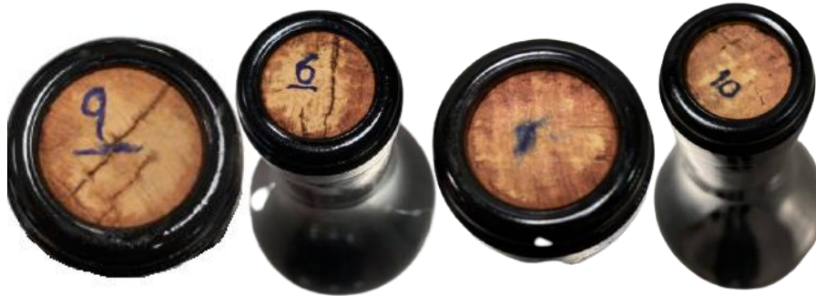
Figura 6. 23. Exemplo de fugas existentes durante os ensaios de absorção em garrafa na condição de 1 semana a 37°C.
