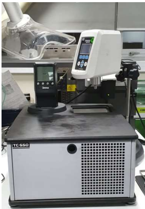
Figura 4.1. Montagem do viscosímetro e do banho termostaticado.
