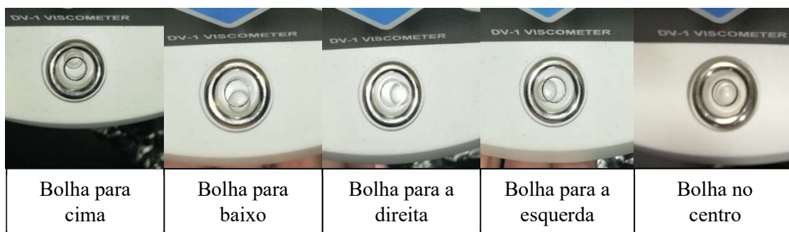
Figura 4.3. Diferentes posições da bolha do nível do equipamento estudadas.
