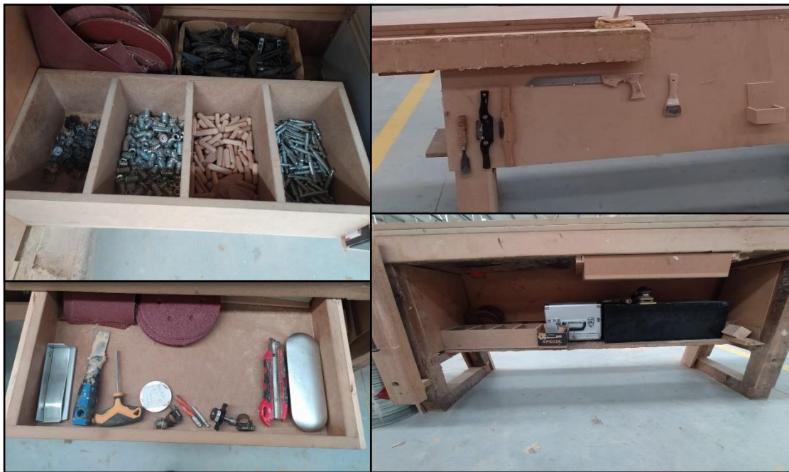
Figura 33 – Organização das ferramentas e ferragens na bancada da marcenaria
