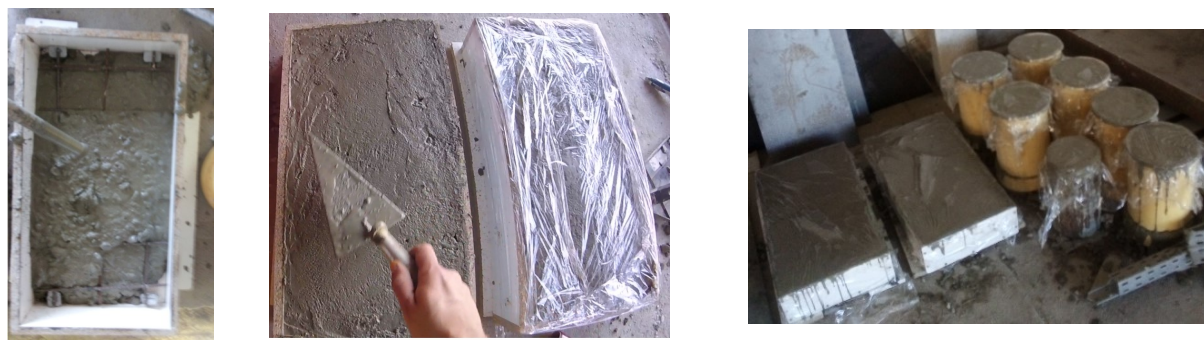
Figura 3.5 - Enchimento dos moldes.
