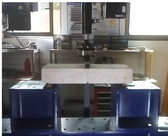
Figura 3.9 - Ensaio à flexão de lajeta com armadura.
