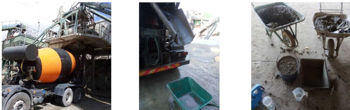
Figura 3.4 - Processo de obtenção das amassaduras.
