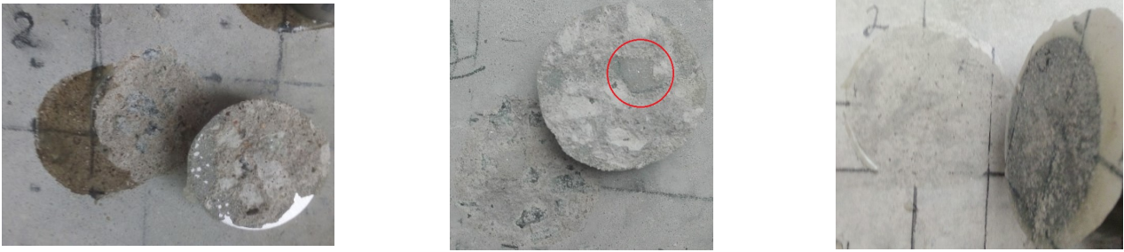
a) Rotura parcial adesivo/disco b) Rotura parcial adesivo/substrato c) Rotura adesivo/substrato
