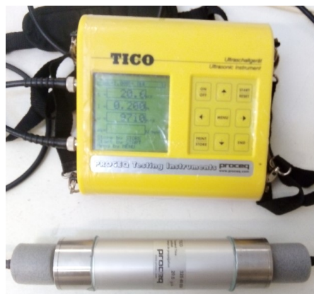
Figura 2.19 - Calibração do aparelho com a barra de referência.
