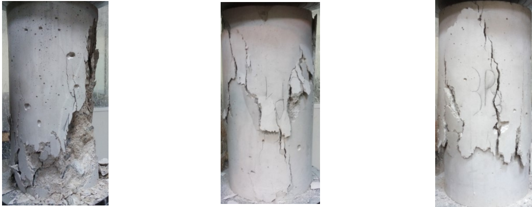
Figura 3.7 - Exemplos tipo das roturas satisfatórias obtidas.
