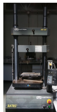
Figura 2.7 - Prensa SATÉC, durante a realização do ensaio determinação da resistência à tração por compressão (LABEST).
