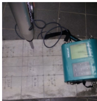
Figura 4.1 - Posição e direção do martelo esclerométrico.
