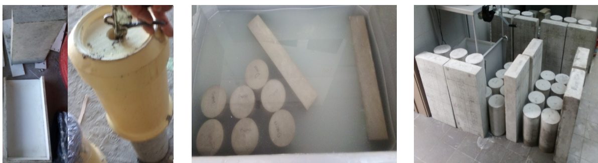
Figura 3.6 - Desmoldagem, colocação em tanque e posterior remoção do tanque de imersão.
