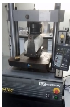
Figura 2.7 - Prensa SATÉC, durante a realização do ensaio determinação da resistência à tração por compressão (LABEST).
