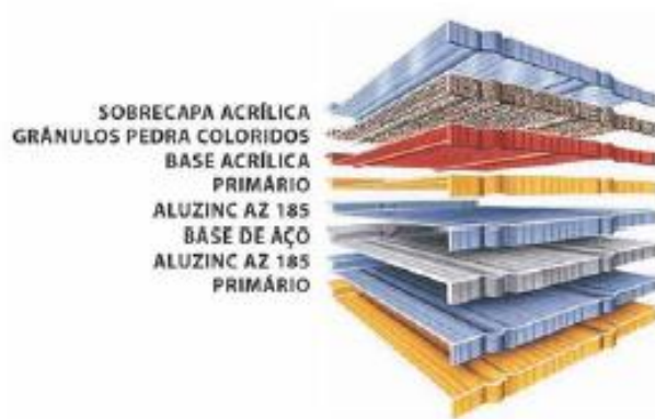
Figura 4.10 – Constituintes de uma telha metálica. (Metrotile, 2008)
