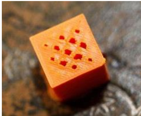
Figura 18 - Exemplo de peça com pillowing [61]
