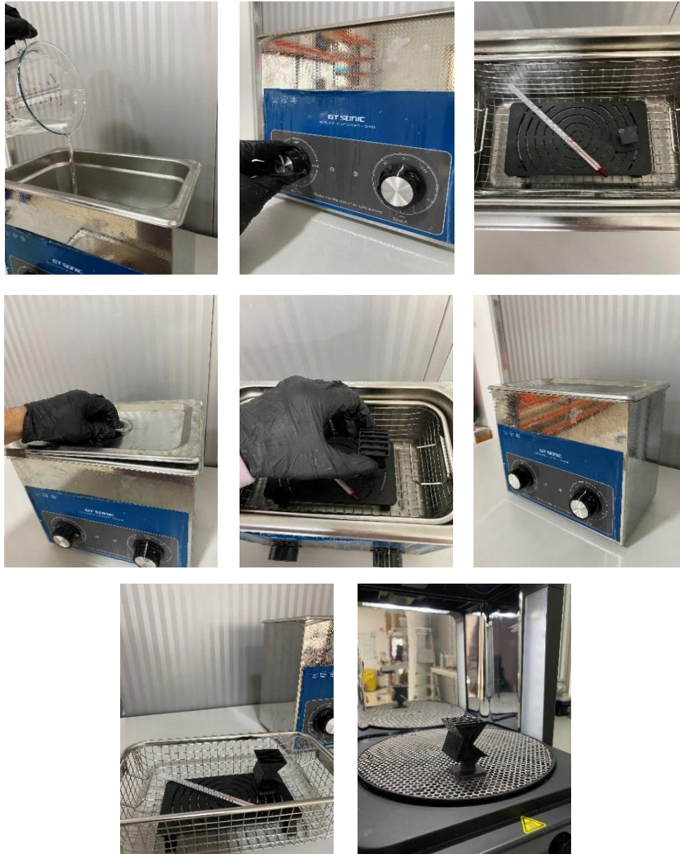
Figura 38 – 1. Colocar a quantidade estipulada de reagente na máquina; 2. Ajustar a temperatura do ensaio; 3. Colocar um termómetro para garantir a temperatura definida; 4. Fechar a tampa de modo ao reagente aquecer e criar vapor; 5. Abrir a tampa e colocar a peça; 6. Fechar a tampa e esperar o tempo estipulado do ensaio; 7. Retirar a conjunto, cesto, base, termómetro e cubo de modo a não tocar neste último; 8. Deixar secar e colocar, posteriormente, o cubo na máquina de cura com a temperatura e o tempo definidos.
