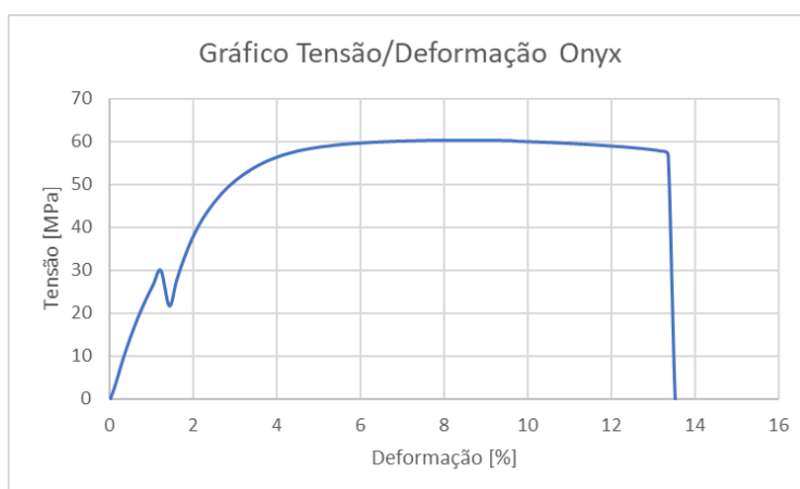
Figura 64 - Exemplo de um gráfico Tensão/Deformação de Onyx
