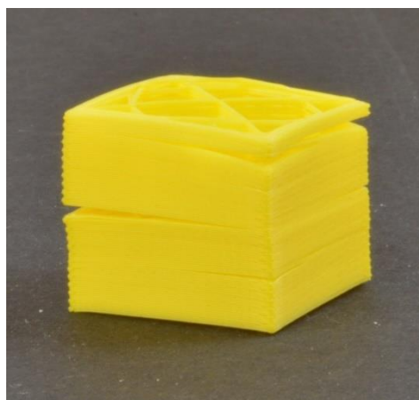
Figura 17 - Exemplo de peça com delaminação [59]
