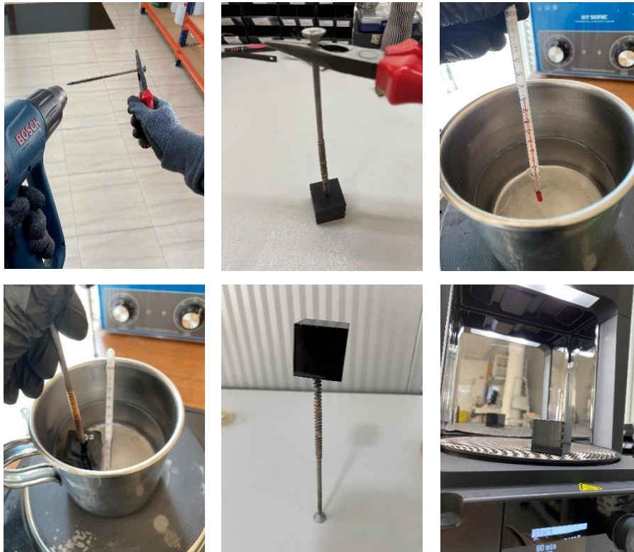
Figura 36 – 1. Aquecer o parafuso com uma pistola de ar quente; 2. Inserir o parafuso na parte inferior do cubo; 3. Regular a temperatura do reagente; 4. Mergulhar o cubo no reagente; 5. Deixar o cubo secar; 6. Colocar o cubo na máquina de cura com a temperatura e o tempo estipulados.
