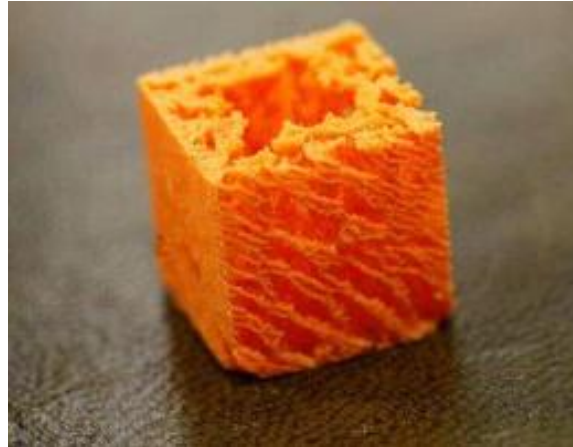
Figura 10 - Exemplo de uma peça com under-extrusion [61]
