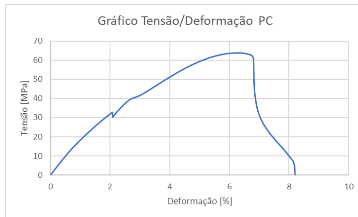
Figura 45 - Exemplo de gráfico Tensão/Deformação de PC
