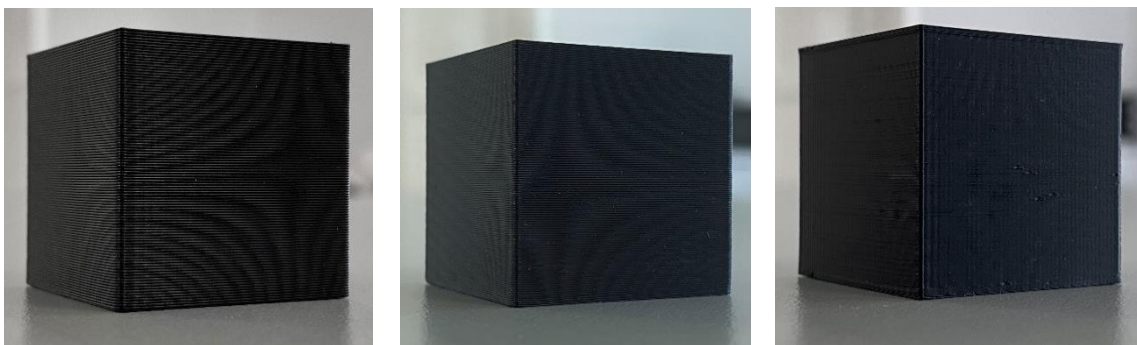
Figura 46 - a) Cubo de Rugosidades com espessura de camada 0,30 mm. b) Cubo de Rugosidades com espessura de camada 0,20 mm. c) Cubo de Rugosidades com espessura de camada 0,10 mm.
