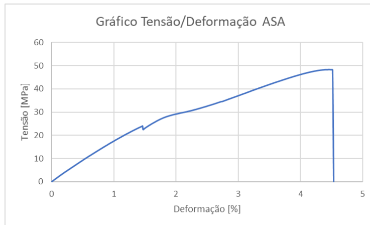
Figura 44 - Exemplo de gráfico Tensão/Deformação de ASA
