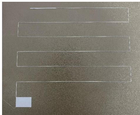
Figura 24 - Calibração " First Layer Calibration " com o filamento Prusament PETG
