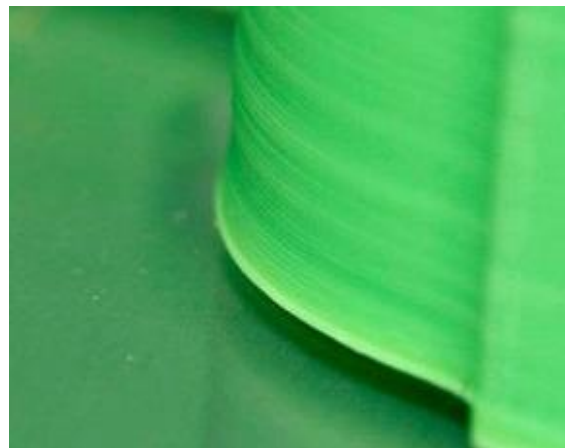
Figura 19 - Exemplo de peça com elephant foot [61]
