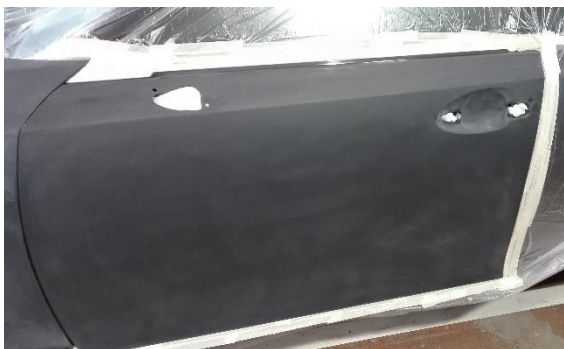
Figura 13 – Exemplo de uma Reparação Tipo 1: pintura de um componente – porta dianteira esquerda.
