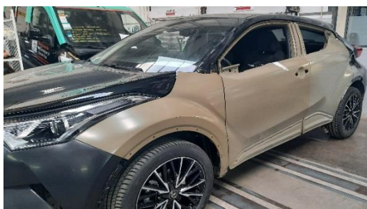
Figura 15 – Exemplo de uma Reparação Tipo 3: Esta viatura sofre um embate central lateral. Como tal, o pilar B/Chassis tiveram de ser tracionados e os respetivos componentes exteriores
