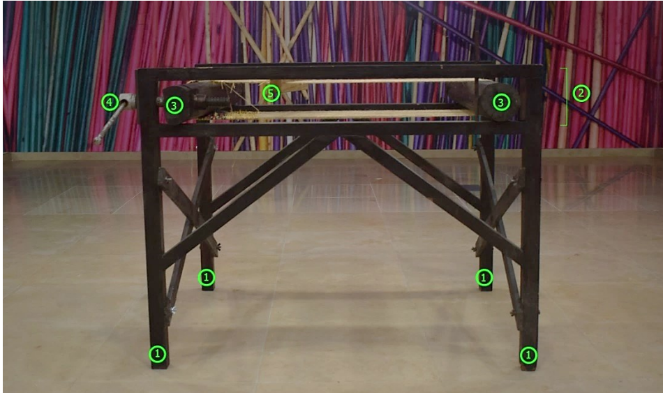
Figura 13- Tear manual: (1) -Pés;(2) -Varandas;(3) -Rolos ou órgãos;
