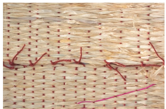
Figura 74- Comparação da leitura com o mesmo padrão. Na parte superior, uso o pente com furos com espaçamentos diferentes, enquanto na parte inferior, os furos do pente têm uma distância regular
