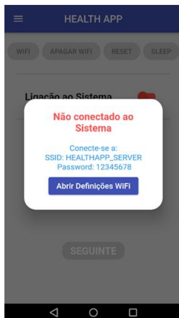
Figura 27 – Pedido de Conexão à Rede do ESP32 para Configuração Wi-Fi
