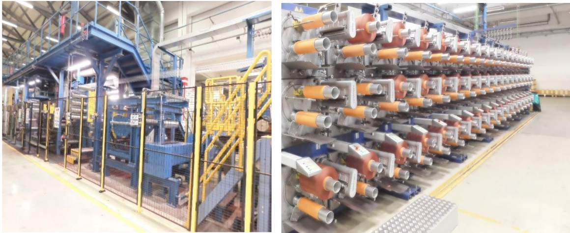
Figura 2.8 - Máquina de impregnação de cordas Single-End 2 .
