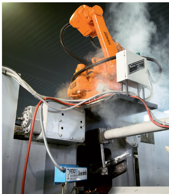
Figura 4.10: Robô lubrificador da ABB utilizado na VDT Vobra (ABB, 2007b).
