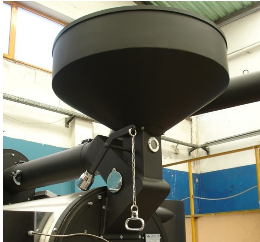
Figura 2.19: Hopper de alimentação [13]
