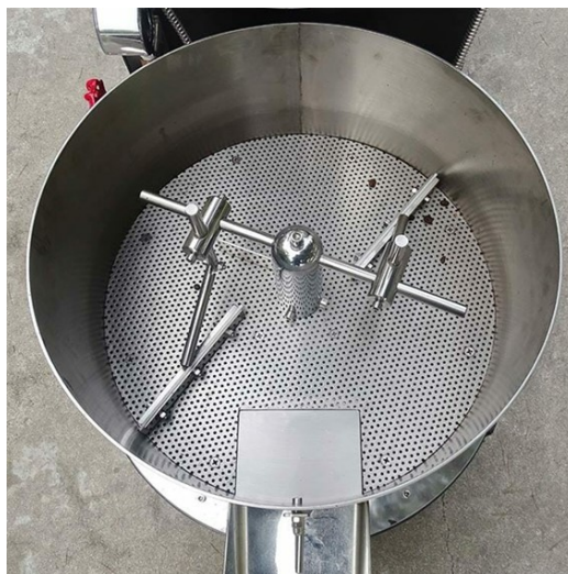
Figura 2.22: Tabuleiro de arrefecimento [15]
