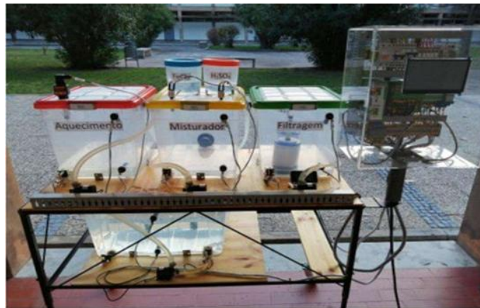
Figura 12 – Simulador didático para sistemas de tratamento de água [56]
