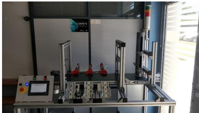
Figura 13 – Bancada didática para ensino de automação DEE [1]
