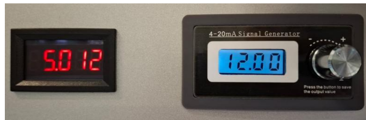
Figura 31 – Equipamentos ligados para validação das variáveis analógicas
