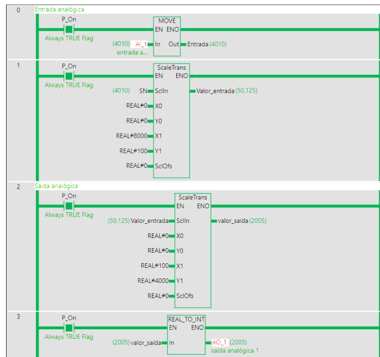
Figura 30 - Simulação da lógica entre entradas e saída analógica do PLC 2
