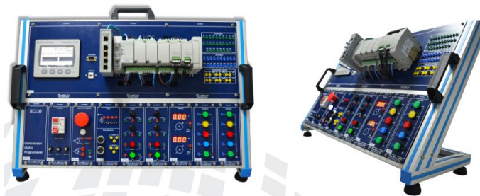
Figura 8 - XC133 – Banco de Ensaio para PLC ROCKWELL (MICRO-850) [48]
