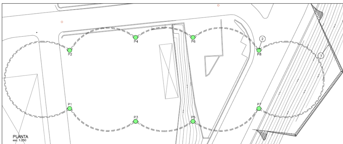
Figura 6.34 - Planta com a implantação das estacas e as suas referências (adaptado CJC, 2009).
