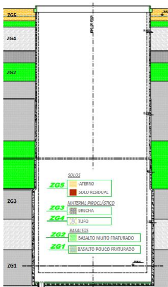
Figura 7.59 - Perfil geológico-geotécnico do poço de ventilação.
