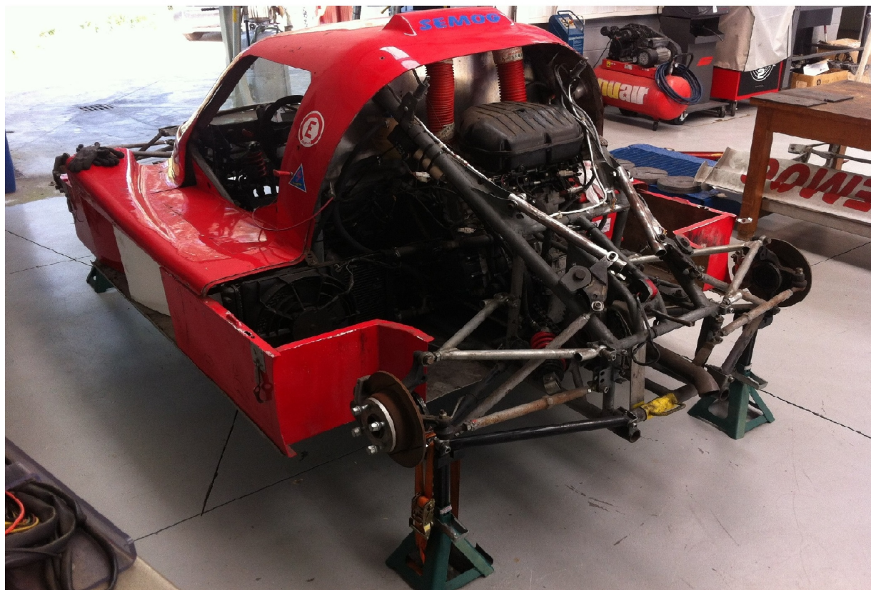
Figura 4.35: Apoios e porta pesos aplicados no chassis
