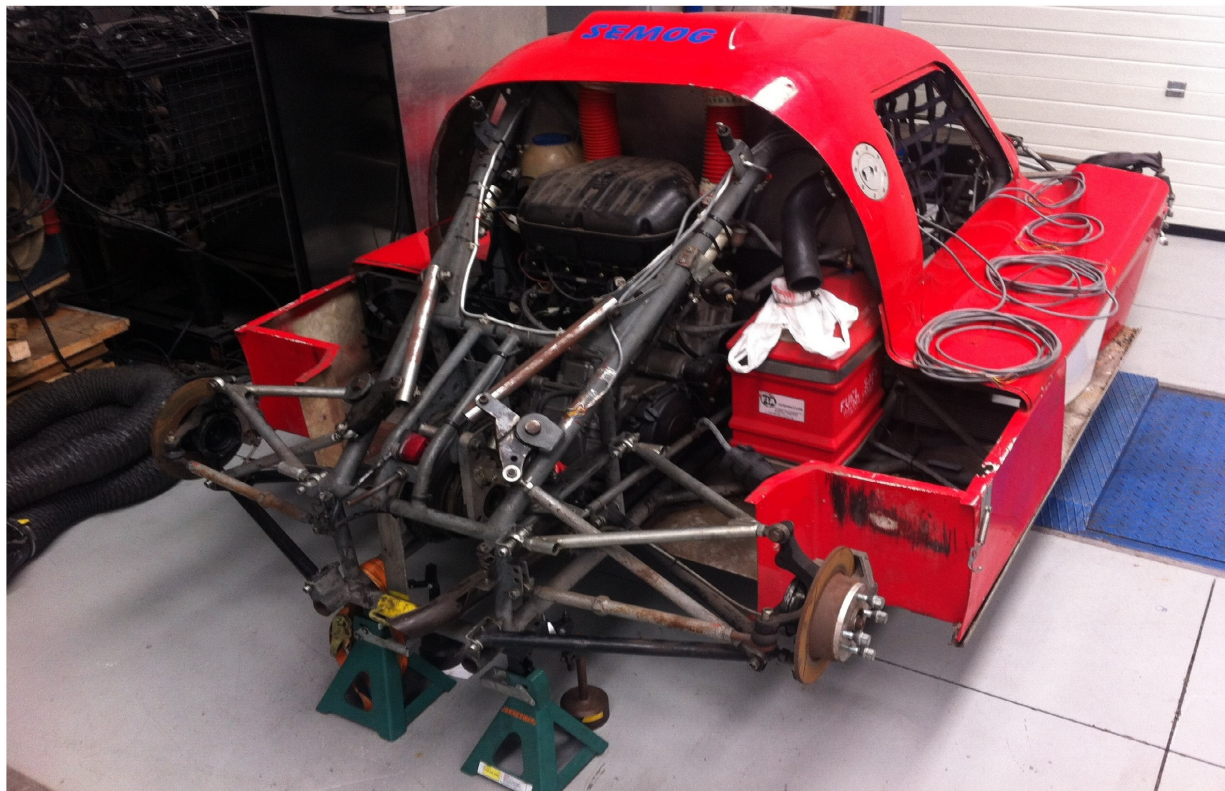
Figura 4.36: Apoios e porta pesos aplicados no quadro
