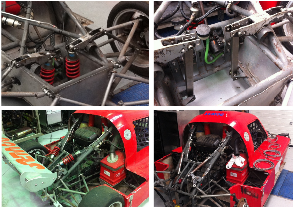
Figura 4.29: Substituição dos amortecedores por tubos metálicos
