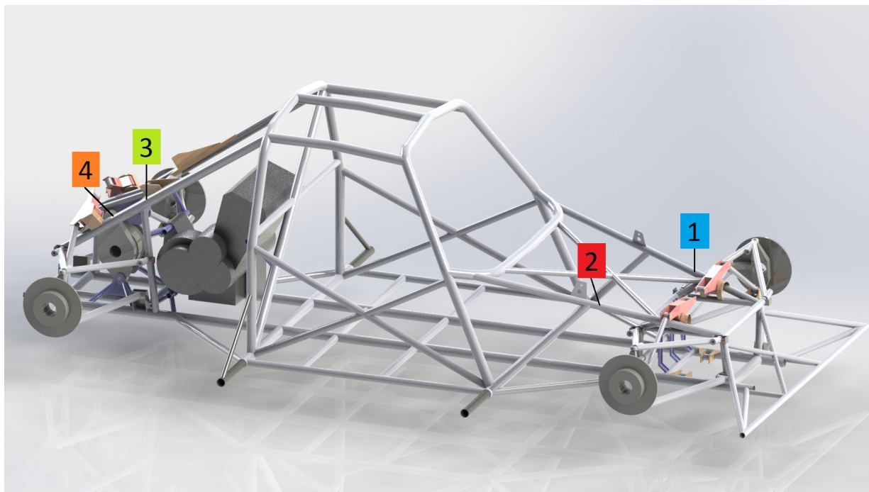
Figura 4.11: Localização dos pontos selecionados para instrumentação com extensometria elétrica
