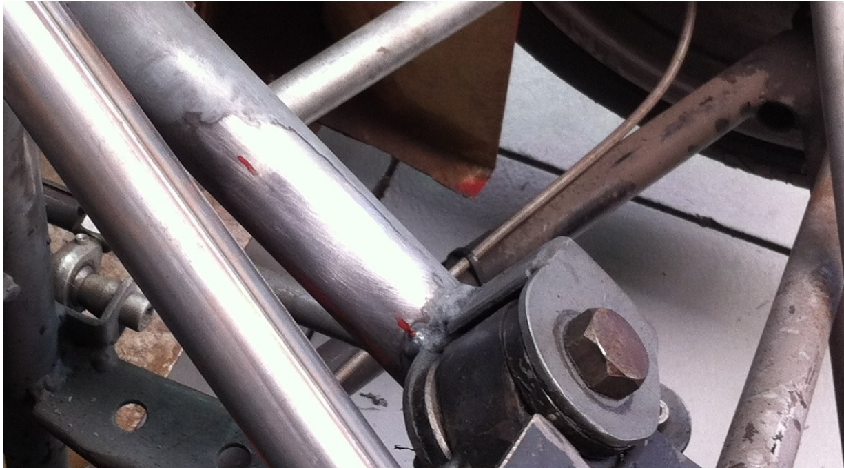
Figura 4.30: Preparação da superfície para colagem das rosetas de extensômetros
