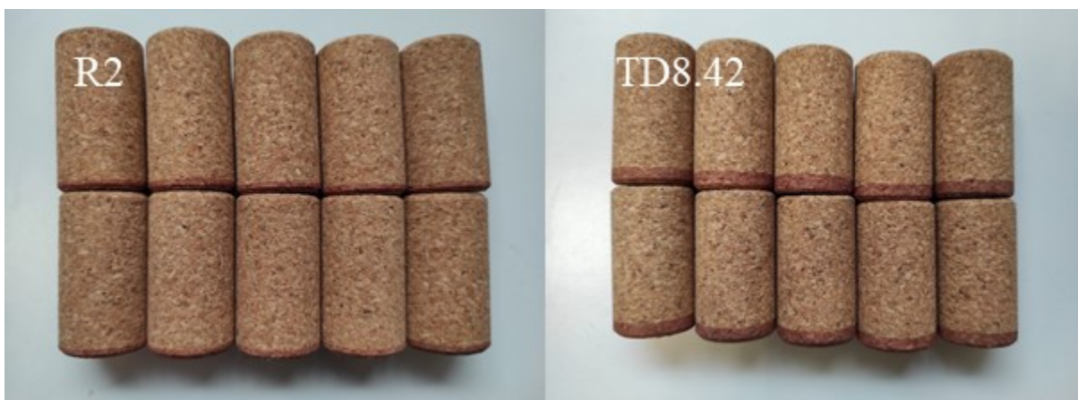
Figura 4.45. Resultados de capilaridade de rolhas Neutrocork® provenientes dos testes R2 e TD8.42, à escala semi-industrial
