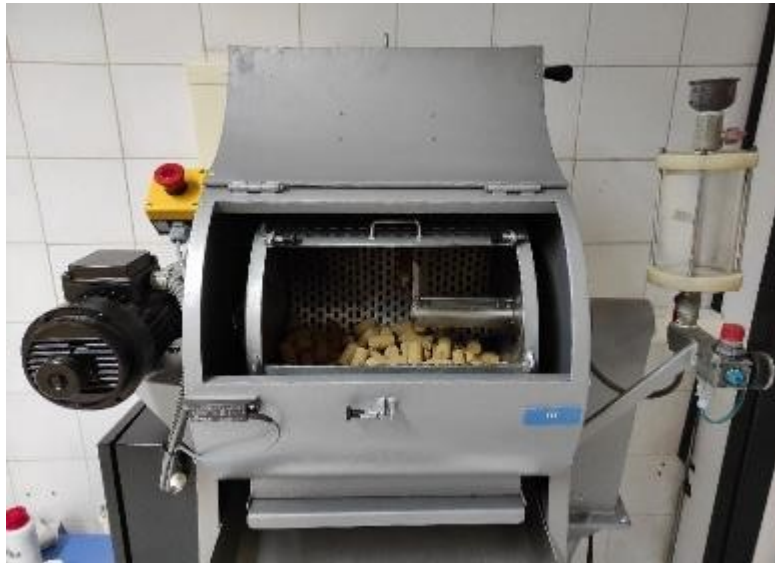
Figura 3.8. Tambor laboratorial de tratamento de superfície da UI Lamas (capacidade: 250 a 500 rolhas).
