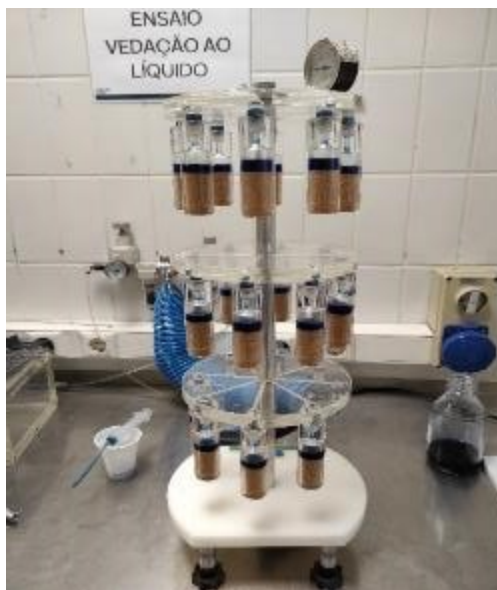
Figura 3.3. Teste de vedação em tubo num carrossel disponível na UI Lamas.
