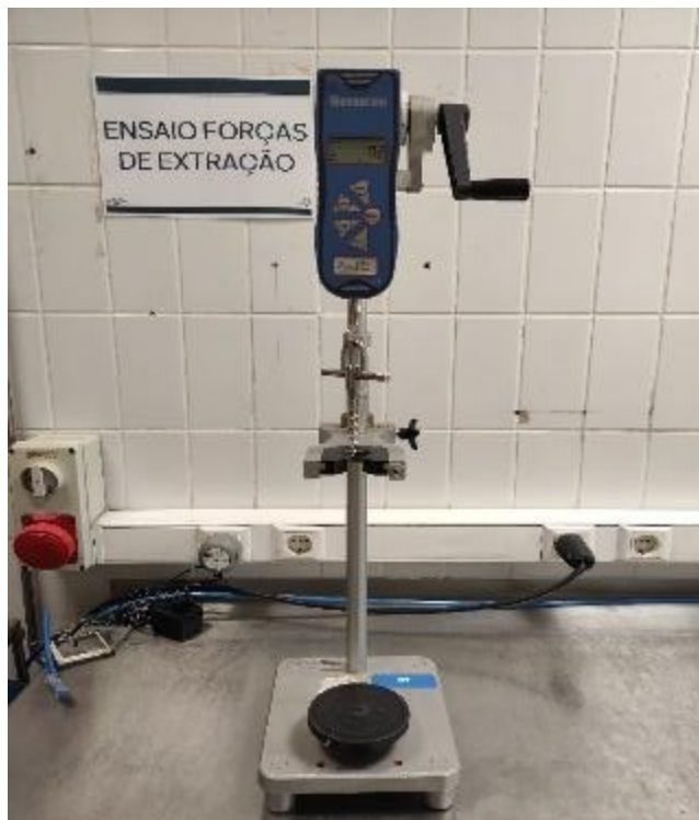
Figura 3.1. Dinamómetro de tração, disponível na UI Lamas (Extralab Portátil).
