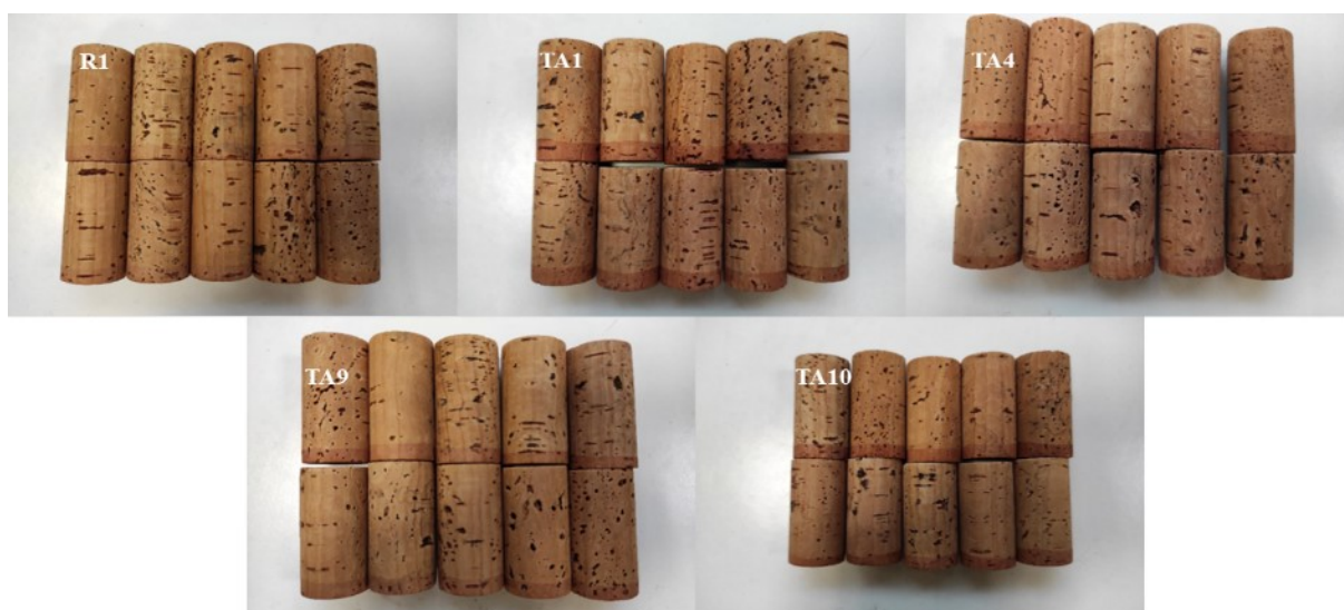
Figura 4.25. Resultados de capilaridade de rolhas naturais provenientes dos testes R1, TA1, TA4, TA9 e TA10, à escala semi-industrial
