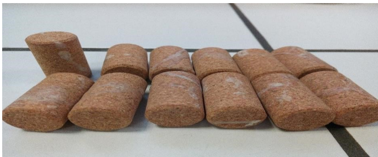
Figura 4.33. Falha de espalhamento do produto D1 (teste TD1) em rolhas Neutrocork® de ensaio à escala piloto
