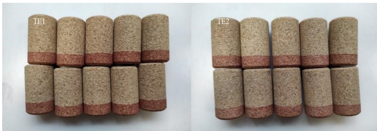
Figura 4.40. Resultados de capilaridade de rolhas Neutrocork® provenientes dos testes TE1 e TE2, realizados à escala piloto
