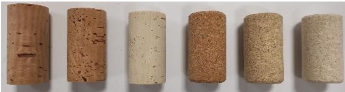
Figura 3.7. Aspeto visual de rolhas naturais e microaglomeradas após diferentes lavagens. Organizadas da esquerda para a direita: Naturais – Sem lavação, L1, L4; Microaglomeradas – L1, L3, L2.
