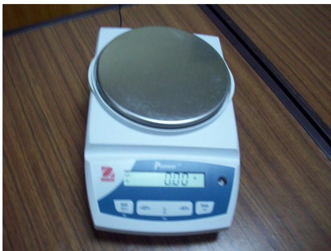
Figura 3.4 - Balança de prato OHAUS (grupo Pioneer TM), carga máxima 4200g e 0,01g de precisão.
