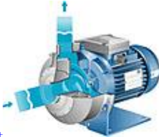
Figura 5:Funcionamento da bomba [1]
