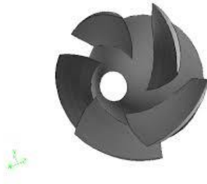
Ilustração 1: Turbina(Runner) de uma bomba centrífuga [3]
