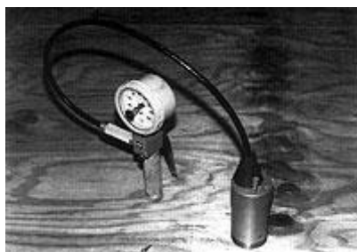
Figura 26: Equipamento para execução do ensaio break-off [15]
